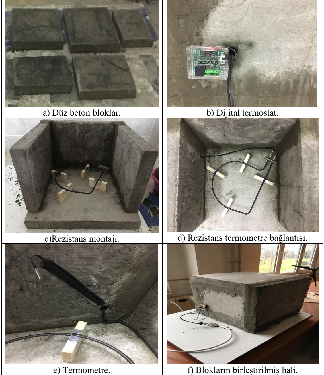
Şekil 7.7 Duvarların birleştirilerek uygulamanın kurulumu.
