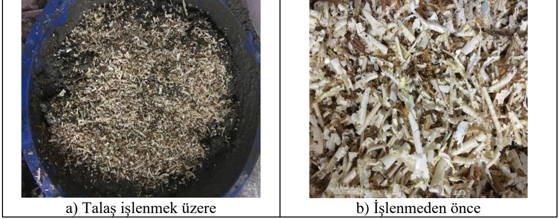
Şekil 6.12 Talaş karışımı değişken beton blok duvarın hazırlanması.
