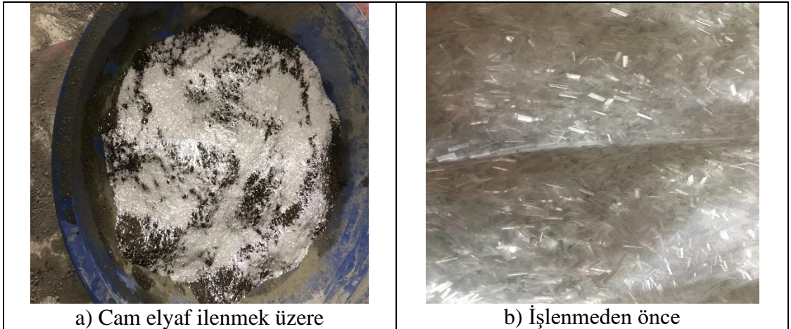
Şekil 6.13-14 Cam elyaf karışımı değişken beton blok duvarın hazırlanması.
