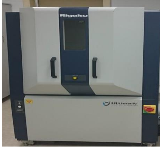
Şekil 4.2. Kompozitlerin XRD analizlerinin yapıldığı X-Işını difraktometresi XRD deney cihazı.
