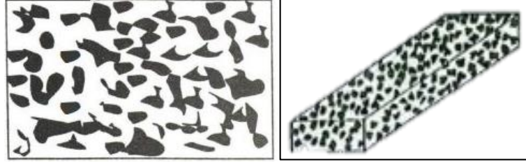
řekil 2.6. Kompozit malzemelerde partiküler yapı [4,5].
