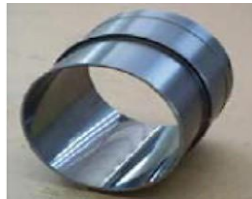
Şekil 2.15. Al metal matrisli kompozit malzemedan üretilen silindir gömleği.
