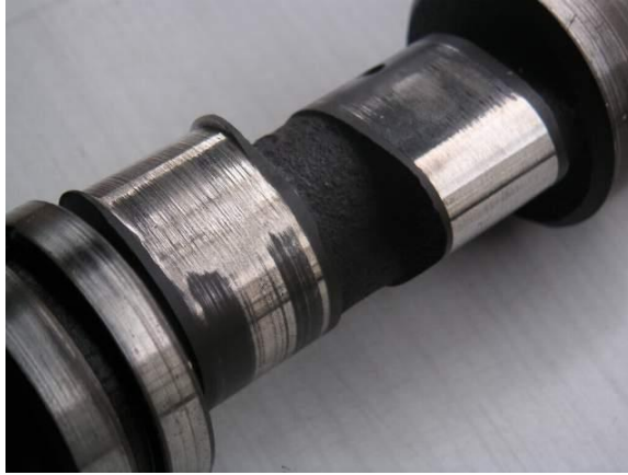
Şekil 3.1. Adhezyon ve abrazyon aşınmasına örnek olarak görüntüdeki kam mili üzerindeki izler [25].
