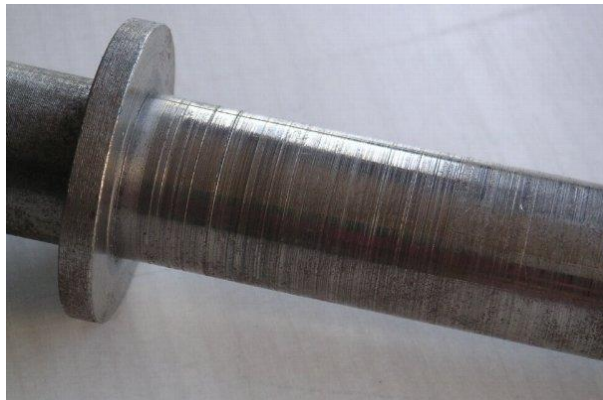
Şekil 3.4. Bir makine milleri üzerindeki abrasif aşınma çizgileri [20,22].
