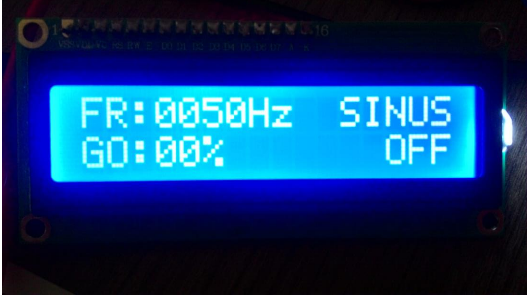
Şekil 3.23. Dalga üretici devresinde üretilen dalganın özelliklerini gösteren ara yüz devresinin ekranı.
