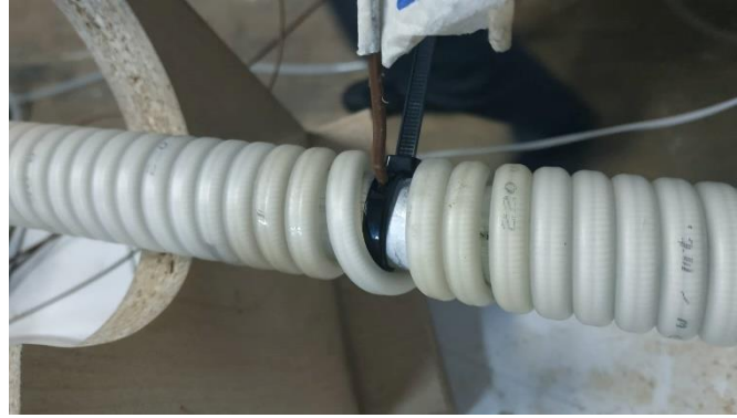
Şekil 3.2. Isıtıcı kablo ve ısı çiftinin konumlandırılması.
