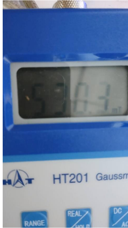
Şekil 3.29. Gaussmetre ile ölçülen en yüksek manyetik alan büyüklüğü değeri.
