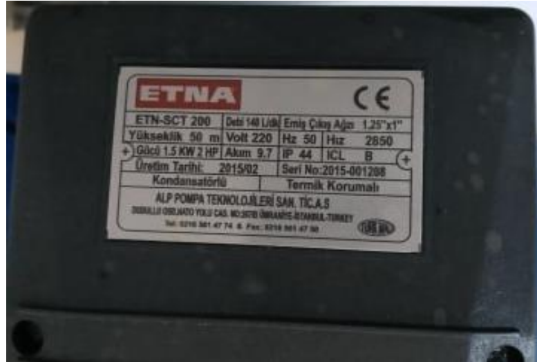
Şekil 3.9. ETNA SCT 200-50 pompa teknik özellikleri.
