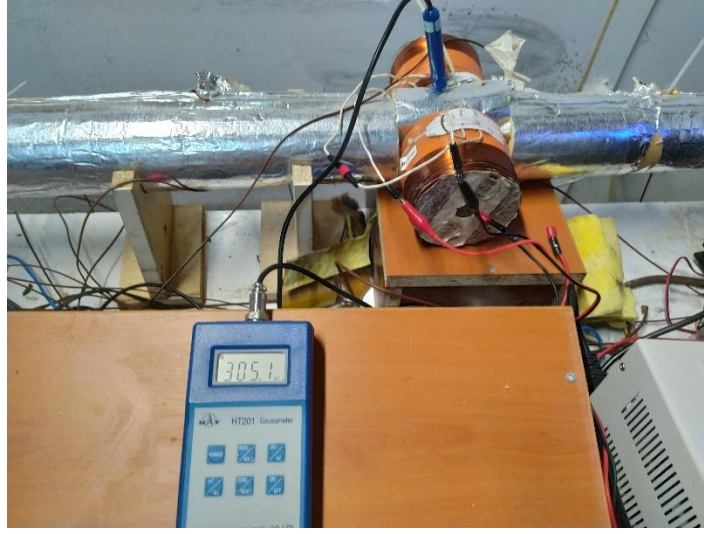
Şekil 3.37. Manyetik alan uygulanan bölgenin konumu ve ölçümü.
