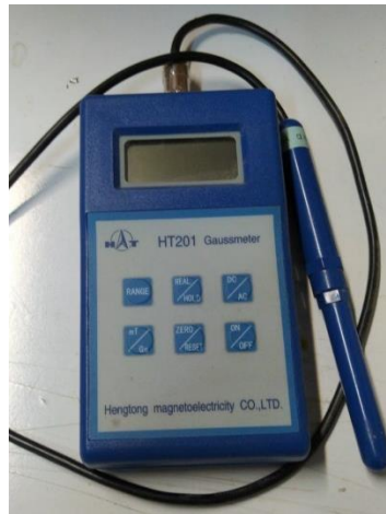
Şekil 3.28. Deneylerde manyetik alan büyüklüğü ölçümü için kullanılan Gaussmetre.
