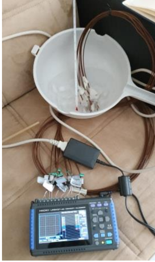
Şekil 3.4. Isıl çift kalibrasyonu.
