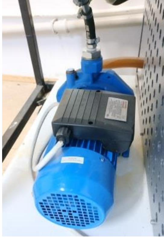
Şekil 3.10. Deneysel çalışmalarda kullanılan pompanın görünümü.
