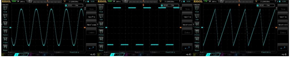
Şekil 3.31. Uygulanan alternatif manyetik alan dalga tiplerinin osiloskop görüntüleri.
