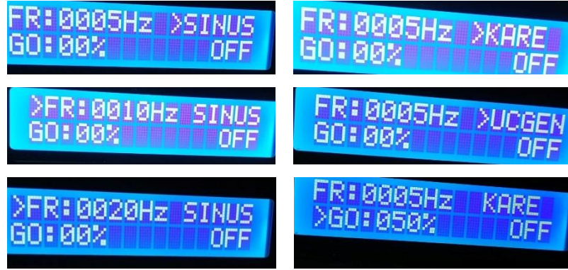
Şekil 3.27. Ara yüzün çeşitli frekans, dalga tipi ve güçte kullanımı.
