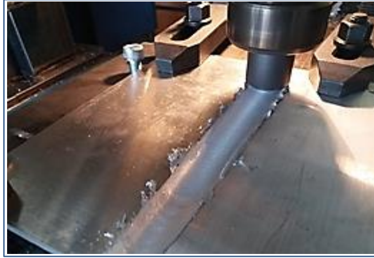
Şekil 6.5. SKK kaynağının yapılışı.
