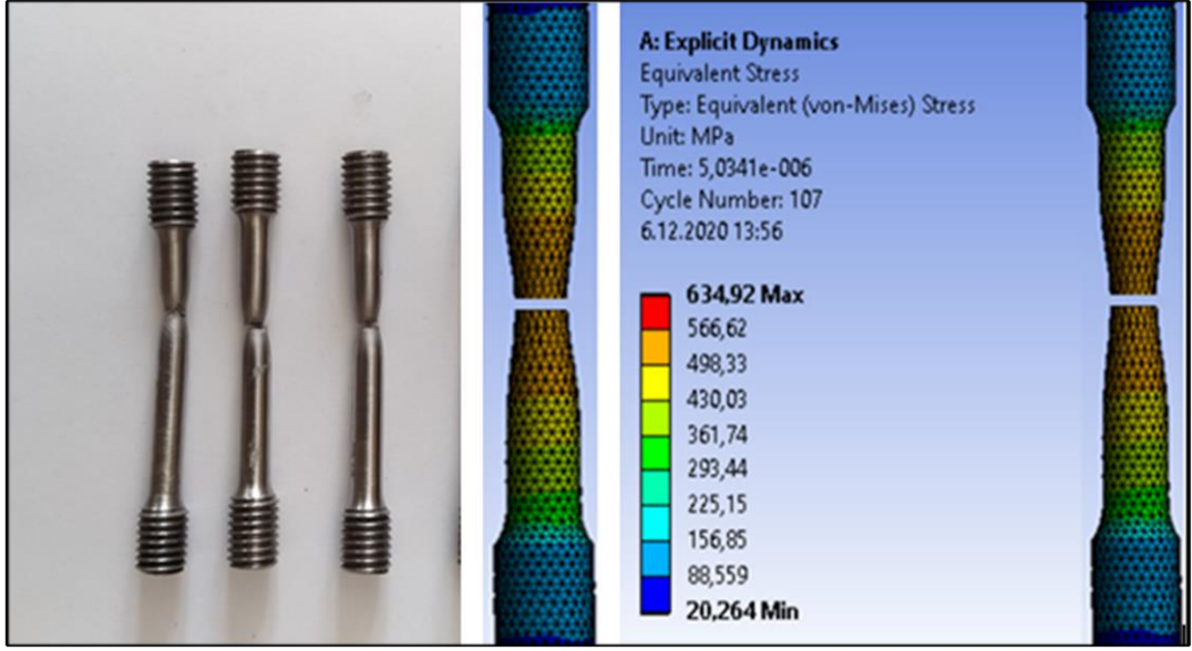
Şekil 5.1. 10^{-3} \text{ s}^{-1} gerinim hızında elde edilen deney ve simülasyon kırılmaları.
