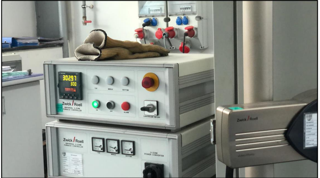
Şekil 4.9. Yüksek sıcaklık çekme testi için ısıtma fırını.
