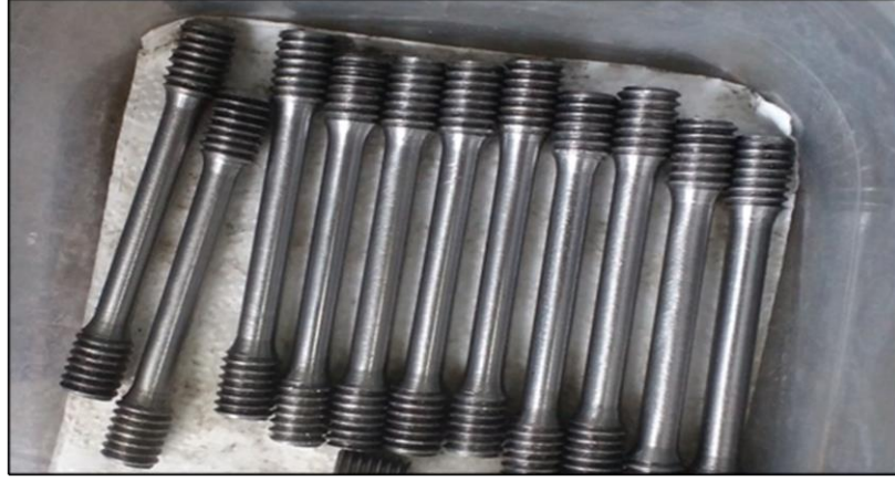
Şekil 4.4. Yarı-statik ve yüksek sıcaklık çekme testleri için oluşturulan numuneler.
