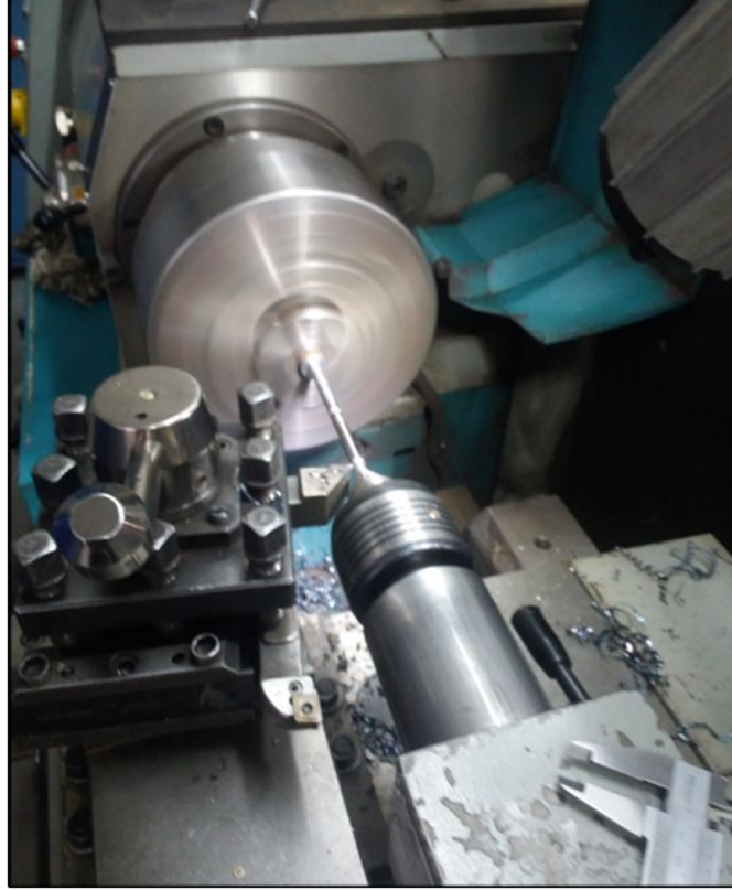
Şekil 4.3. Torna tezgâhı numune oluşturma.
