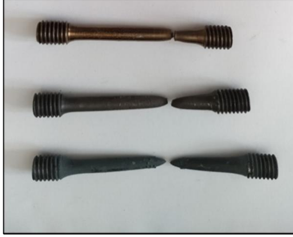
Şekil 4.10. Referans gerinim hızında ( 10^{-3} \text{ s}^{-1} ), 300 °C, 600 °C ve 900 °C sıcaklıkları için çekme testi uygulanan numuneler.
