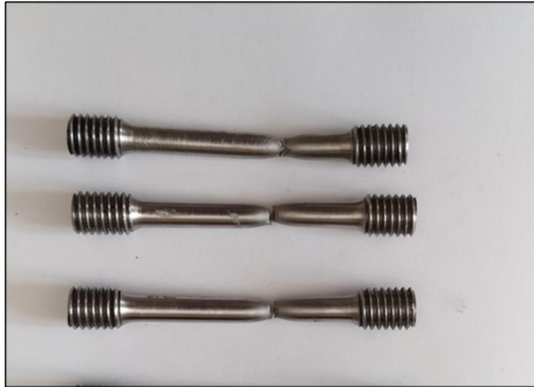
Şekil 4.8. Oda sıcaklığında (24 °C), 10^{-1} , 10^{-2} ve 10^{-3} s -1 gerinim hız değerlerinde çekme testi uygulanan numuneler.
