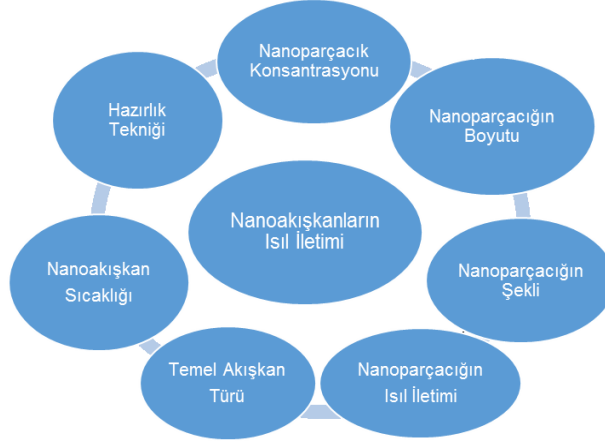
Şekil 3.5. Nanoakışkanların ısı iletkenliğinin bağılı olduğu parametreler [44].
