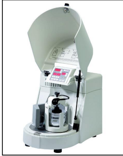
Şekil 5.2. Fritsch Pulverisette planer tip öğütme/alaşımlama cihazı.
