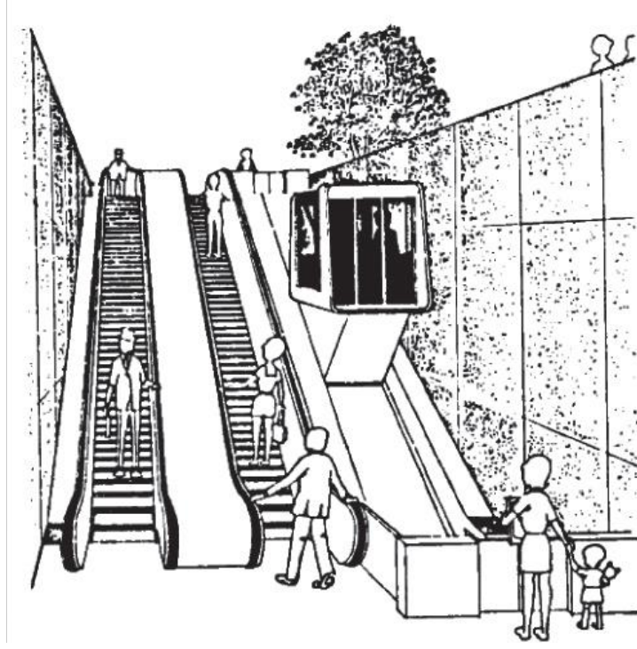
Şekil 3.24. Merdiven eğiminde eğik asansör (TS 12576, 1999)
