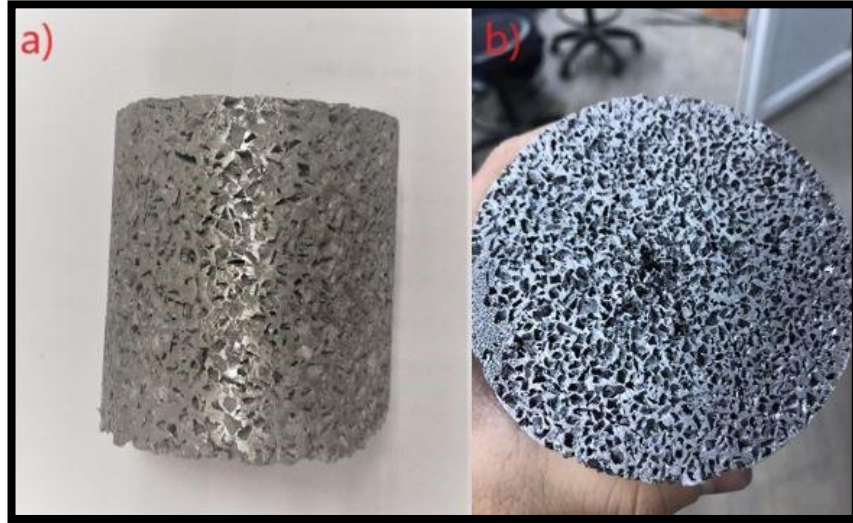
Şekil 4.6. 5083 Al alaşımlı köpük görünümleri a) büyük gözenekli Al köpük b) küçük gözenekli Al köpük.
