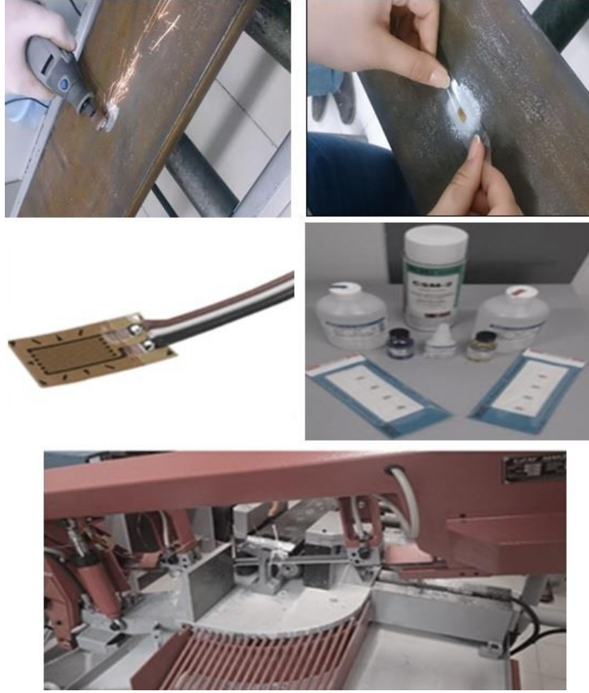
Şekil 4.4. Gerinim ölçerin yapıştırılması, deneyde kullanılan malzemeler ve kesme aşaması.
