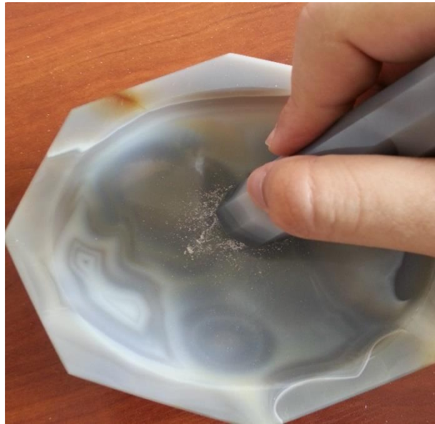
Şekil 3.9. Agat havanda toz haline getirme işlemi.
