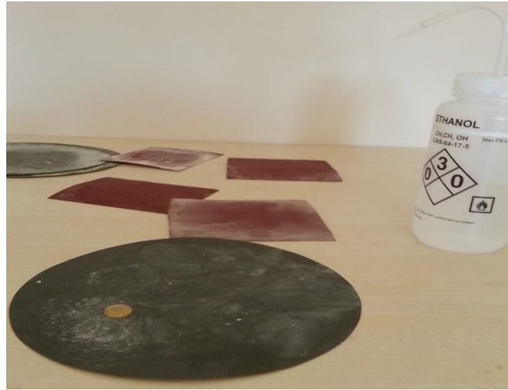
Şekil 3.5. Numunelerin parlatılması ve parlatma malzemeleri.
