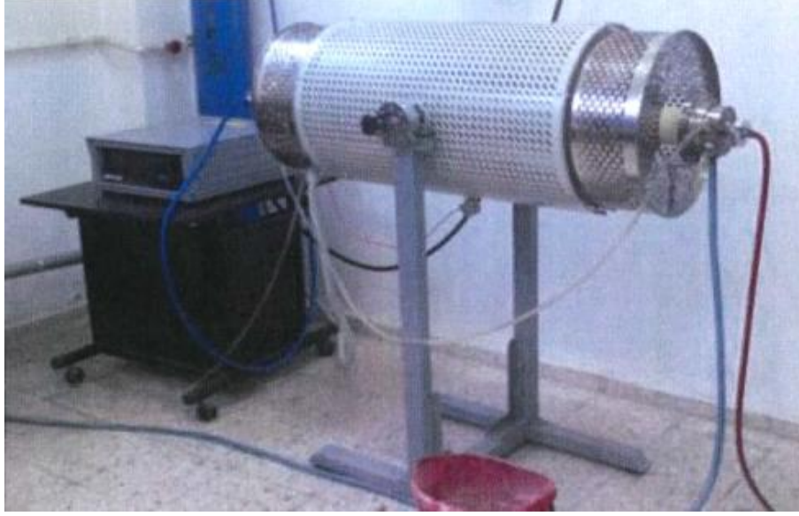
Şekil 5.3. Sinterlemede kullanılan atmosfer kontrollü fırın görüntüsü.
