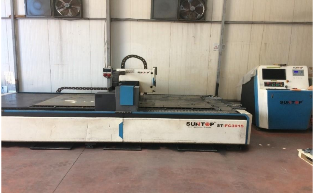
Şekil 6.1. Lazer kesme cihazı ve kontrol paneli (SUNTOP ST-FC 3015).
