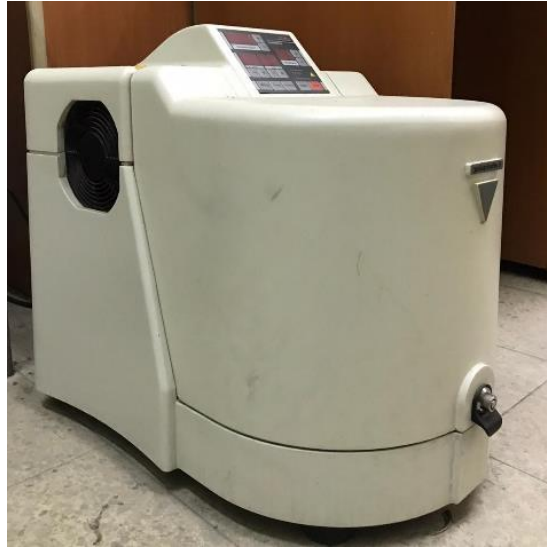
Şekil 7.1. Mekanik alaşımlama cihazı.
