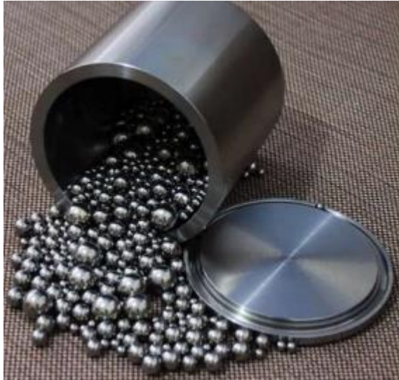
Şekil 5.5. Öğütme kabında ki bilyeler (Milli, 2017).
