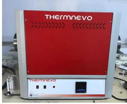
Şekil 7.4. Sinterleme işleminin yapıldığı fırın.
