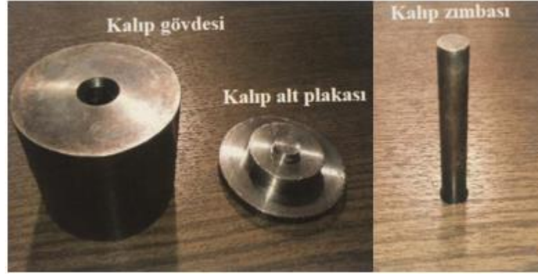
Şekil 7.2. Presleme işleminde kullanılan kalıp.
