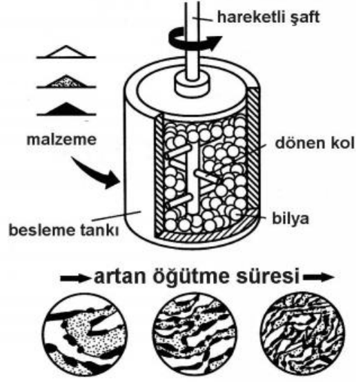
Şekil 5.4. Mekanik alaşımlama hazne ve bilye (Milli, 2017).
