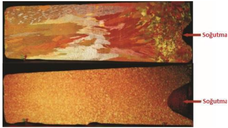
Şekil 2.13. 3004 alaşımlı dökümde tane yapısı (üstte tane inceltici eklenmemiş, altta 5Ti-B olarak 10 ppm seviyesinde B eklenmiş) [41].
