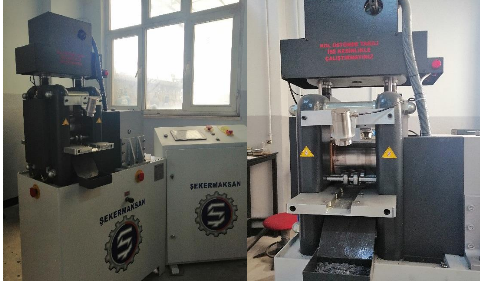
Şekil 3.10. Şekermak haddeleme cihazı.
