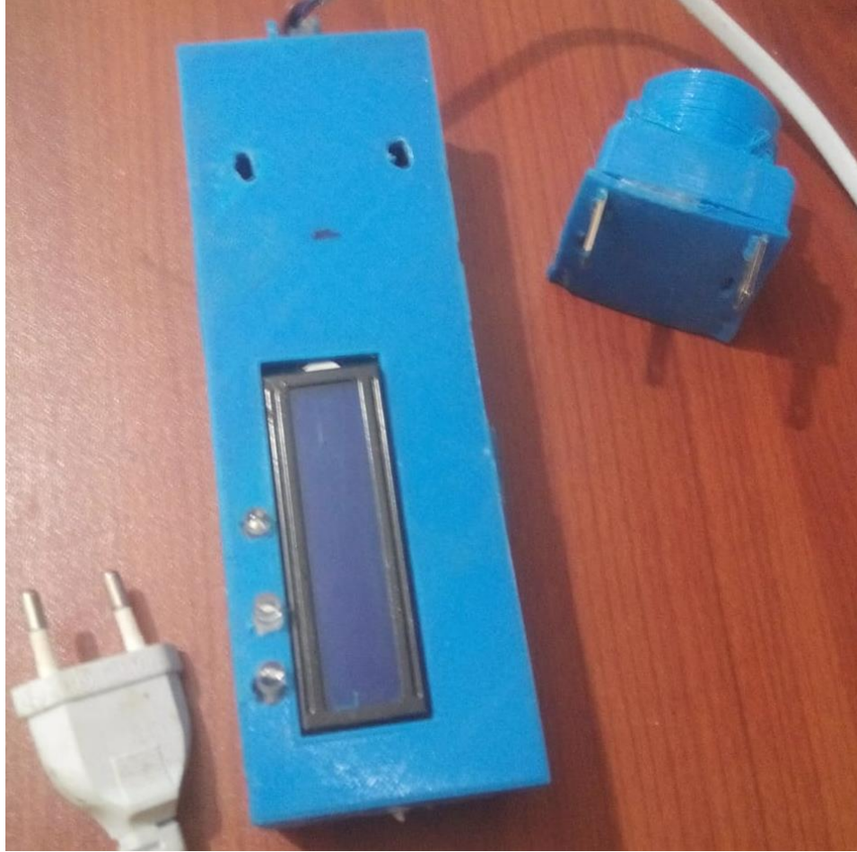
Şekil 6.1. 3D Yazıcı ile üretilen fiş ve priz sistemi.
