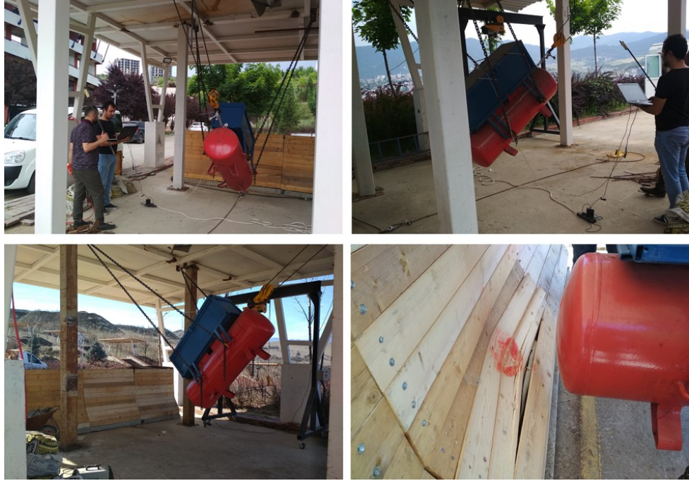
Şekil 7.3. Pandül sistemi kullanılarak gerçekleştirilen deneme çarpışmaları.
