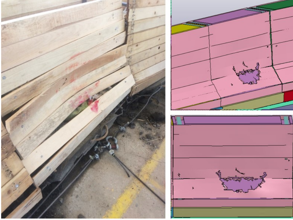
Şekil 8.4. B1K2 grubu YHB üzerinde çarpışma sonrası kırılan köknar keresteler.
