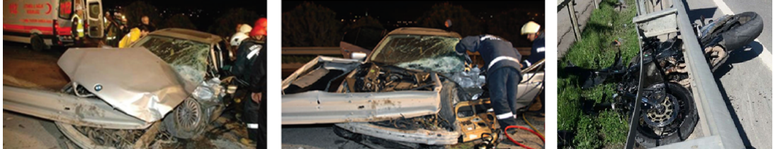
Şekil 2.2. Çelik bariyerlerde ortaya çıkan güvenlik sorunlarına örnekler.
