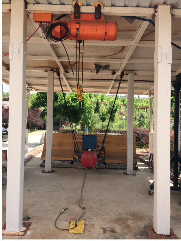
Şekil 6.13. Direkler ile güçlendirilmiş gerçek zamanlı çarpışma sistemi.
