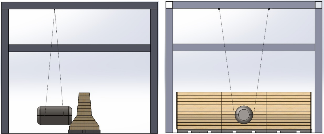
Şekil 8.1. “Solidworks” programı kullanılarak çizilmiş gerçek zamanlı çarpışma (pandül) sistemi.
