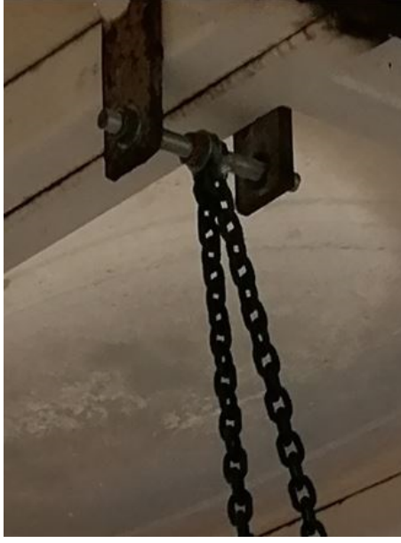
Şekil 6.9. Pandülü taşıyacak mil ve yatakları.
