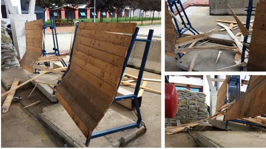
Şekil 7.7. Sadece ahşap kullanılarak üretilen bariyerin çarpışma testi.
