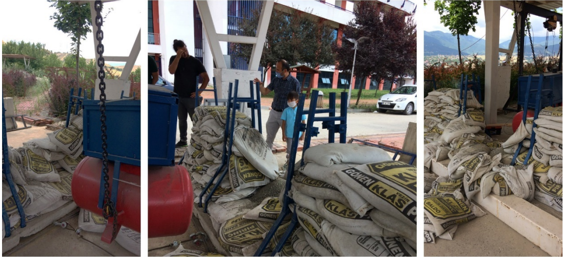
Şekil 7.6. Sadece kum kullanılarak üretilen bariyerin çarpışma testi.
