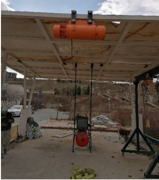
Şekil 6.12. 2 ton kapasiteli vinç
