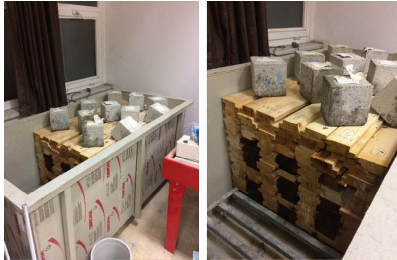
Şekil 3.18. Köknar kerestelerin su havuzuna yerleştirilmesi.
