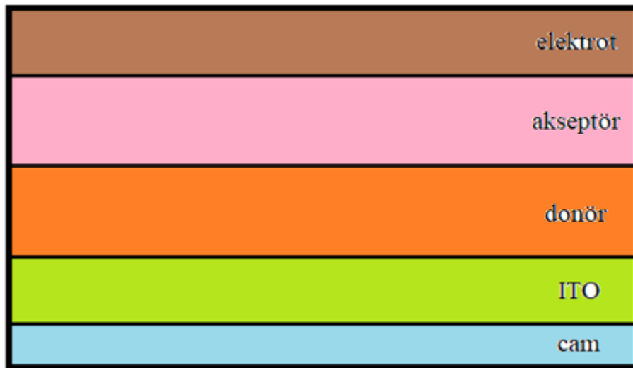
Şekil 2.6. Çift katmanlı organik güneş panel şeması.
