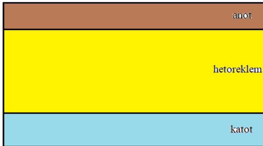
Şekil 2.7. Heteroeklem katmanlı organik güneş panel şeması.
