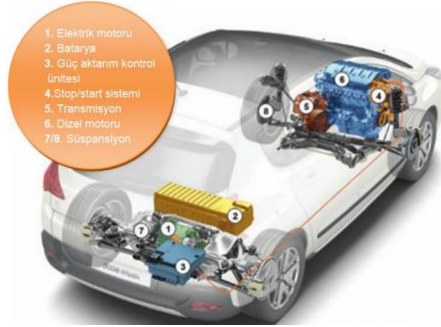
Şekil 1.5. Hibrit elektrikli aracın iç yapısı ve elemanları [8].
