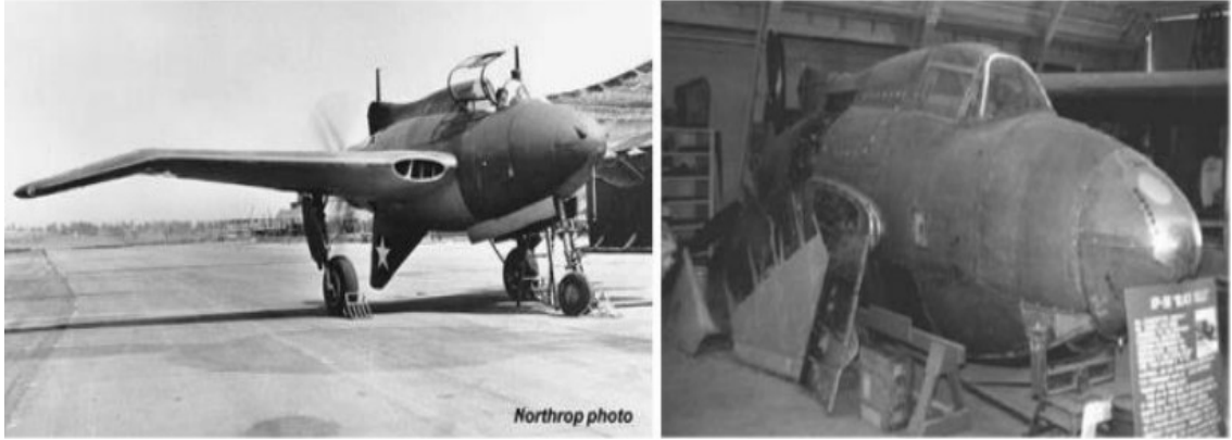
Şekil 2.2. Mg alaşımlarından yapılmış olan ilk uçak Northrop XP-56 [16].
