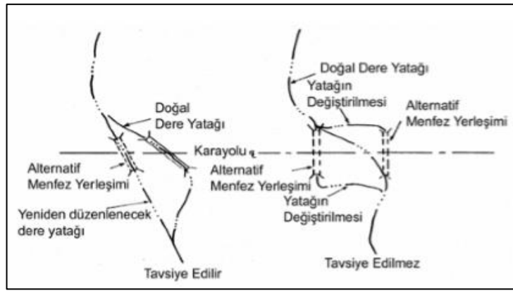
b) Düzenlenmiş dere yatağı üzerinde menfezlerin yerleşimi
