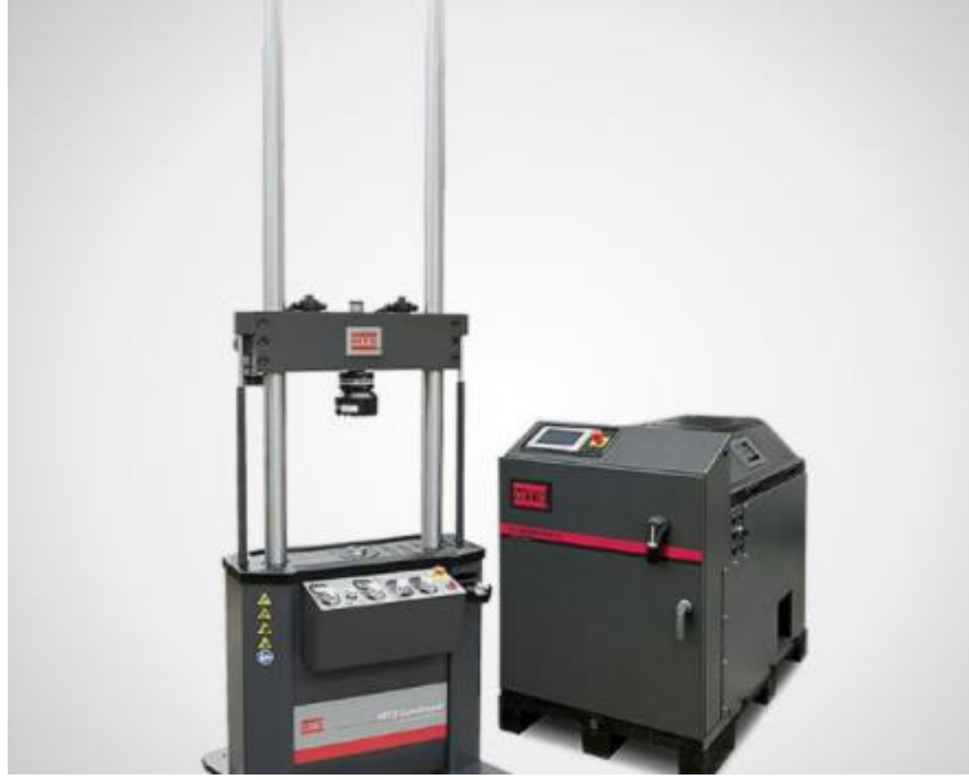
Şekil 10.8. MTS marka 100 kN servo hidrolik dinamik.
