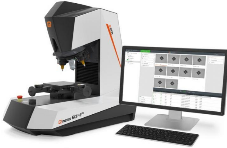
Şekil 10.6. Qness Q+ marka HMV sertlik ölçüm cihazı.
