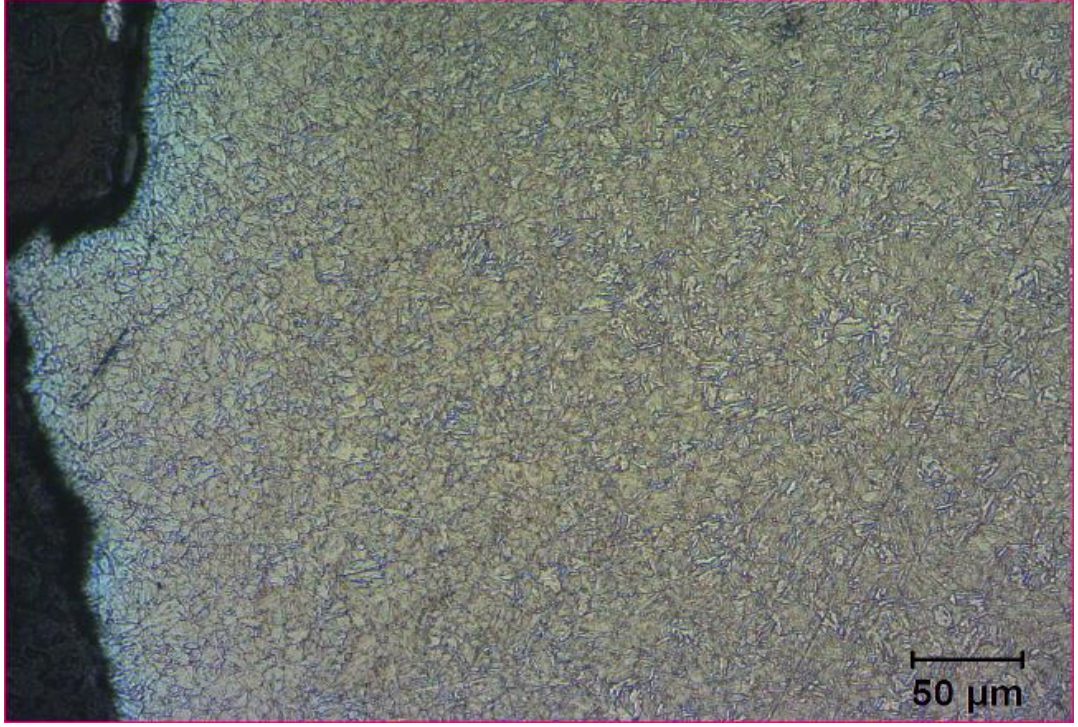
Şekil 11.2.Tempcore işlemi ile üretilmiş B420C kalite betonarme çeliğin dış yüzey mikro yapısı (200X).
