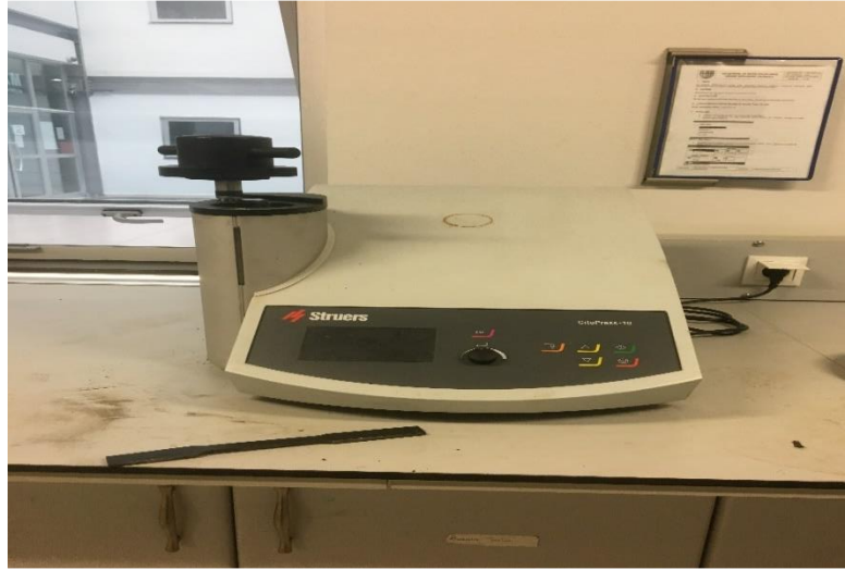
Şekil 10.3. Citopress-10 sıcak kalıplama cihazı.
