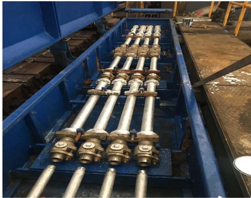
Şekil 6.8. Tempcore soğutma sistemi nozul yerleşimi.
