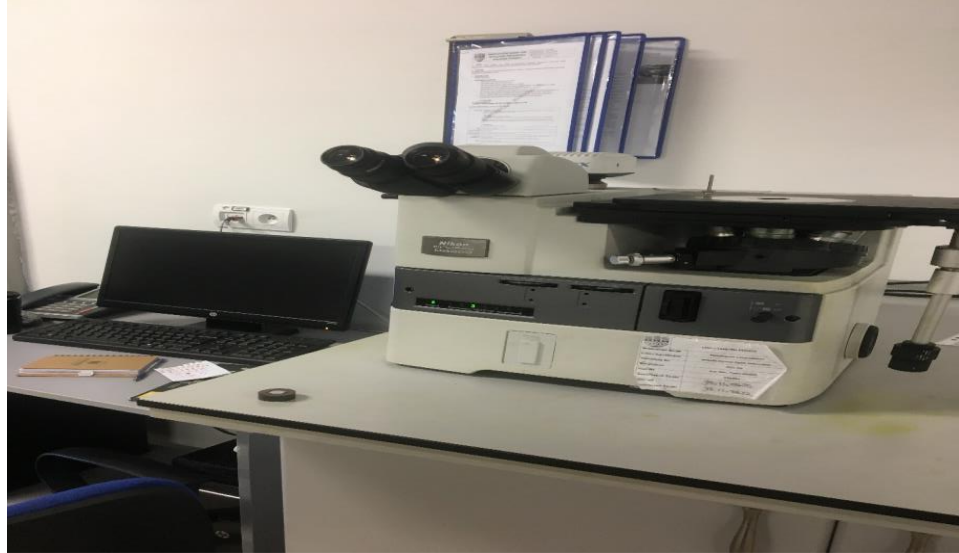
Şekil 10.5. Nikon Eclipse MA200 ters metalurjik mikroskopyu.
