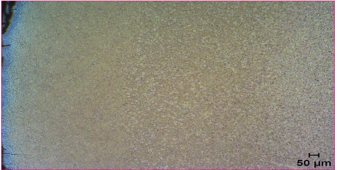
Şekil 11.3.Tempcore ile üretilmiş betonarme çeliğin yüzey bölgesi mikroyapısı (50X).
