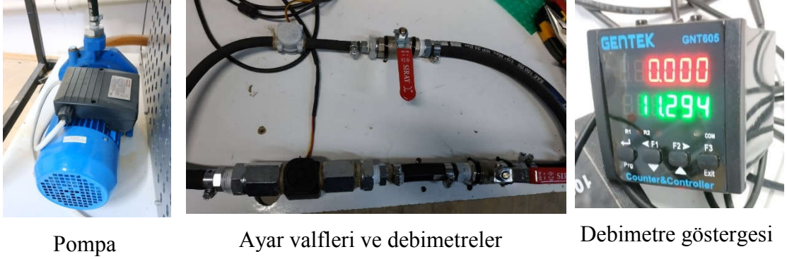
Şekil 3.4. Pompa ve debimetrelere ait görüntüler.
