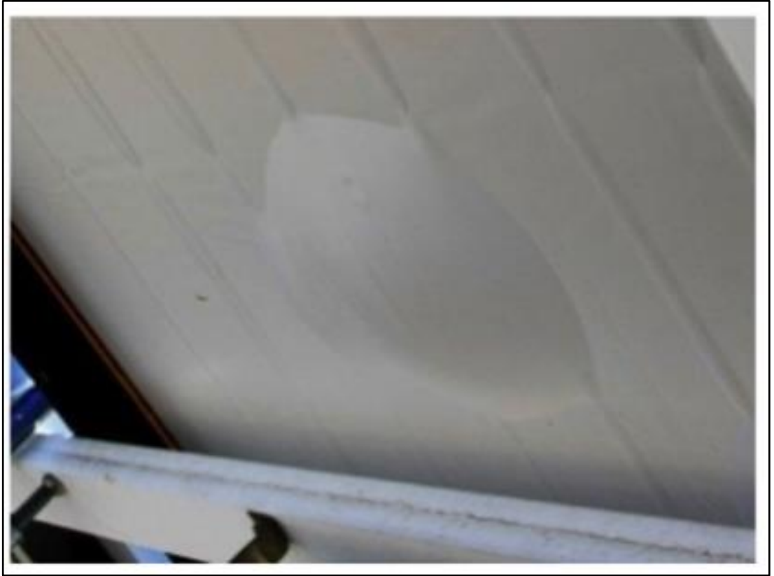
Şekil 3.7. Arka tabaka yapışma hatası.
