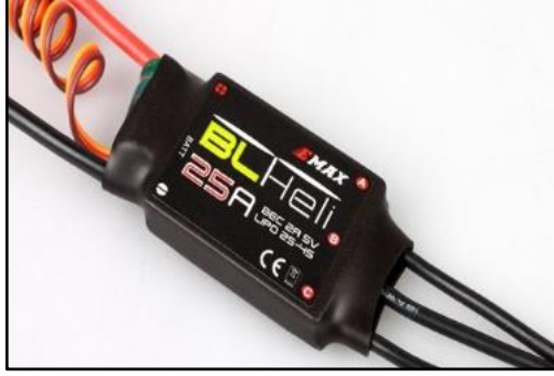
Şekil 4.19. EMAX marka BLHeli 25A model ESC.
