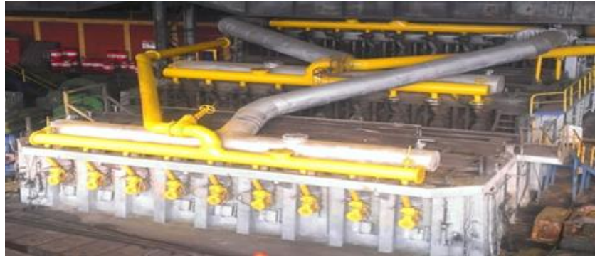
Şekil 2.4. Kontinü haddehane tesisi tav fırını.
