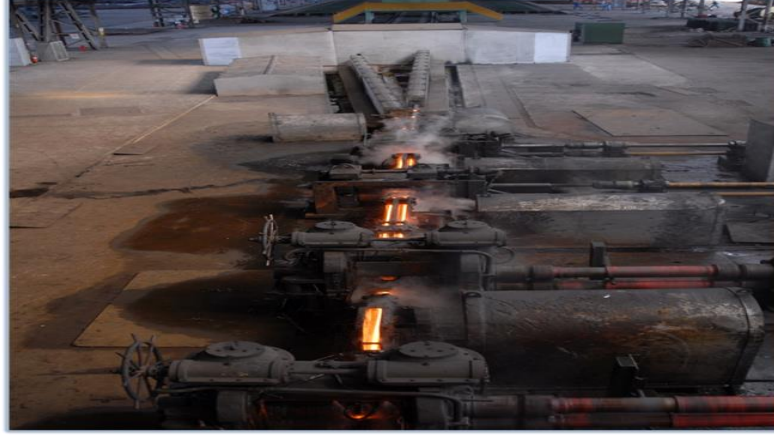
Şekil 2.5. Kontinü haddehane tesisi hadde tezgahı.
