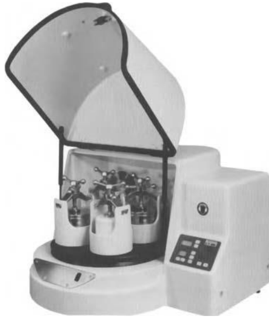
Şekil 2.2. Planetary tipi öğütücü (C. Suryanarayana, 2003).
