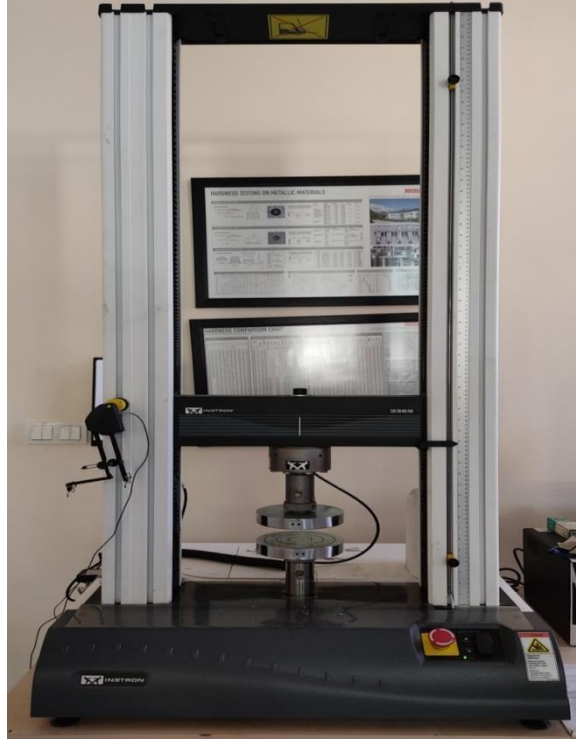
Şekil 5.14. Instron 3369 marka basma-çekme test cihazı.
