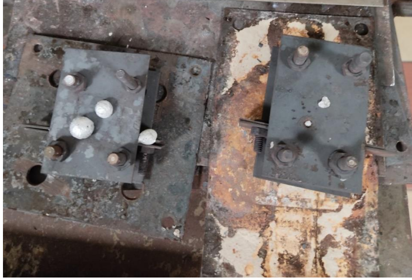
Őekil 5.10. Al 6061 alařımının kapalı kalıpta 750 °C (solda) ve 725 °C de (sađda) köpürmeleri
