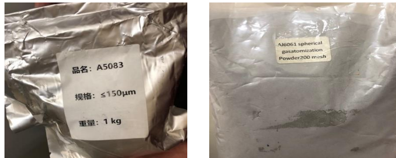
Şekil 5.1. 150 \mu\text{m} 'lik Al 5083 ve Al 6061 Tozları
