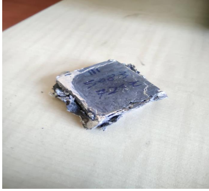
Şekil 6.7. Al5083 alaşımının 3. numunesinin 725 °C’de maksimum sıkıştırma gerilimi 55,941 MPa olarak uygulanan basma sonucu fiziksel durumu.
