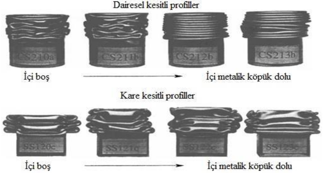
Şekil 2.20. Eksenel yük altındaki boş ve metalik köpük ile dolu dairesel ve kare profiller Hannes ve diğerleri (2010).
