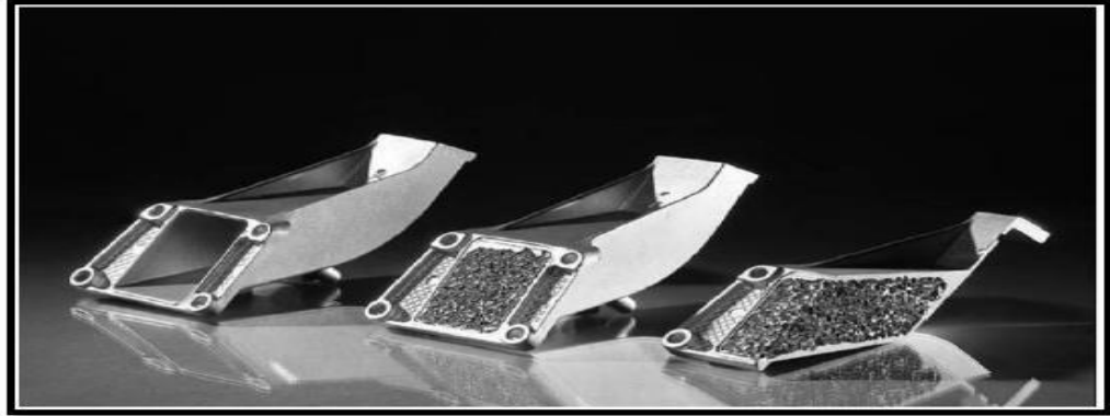
Şekil 4.3. Otomobillerde kullanılan köpük dolgulu bağlantı parçaları (Demirhan, 2010).
