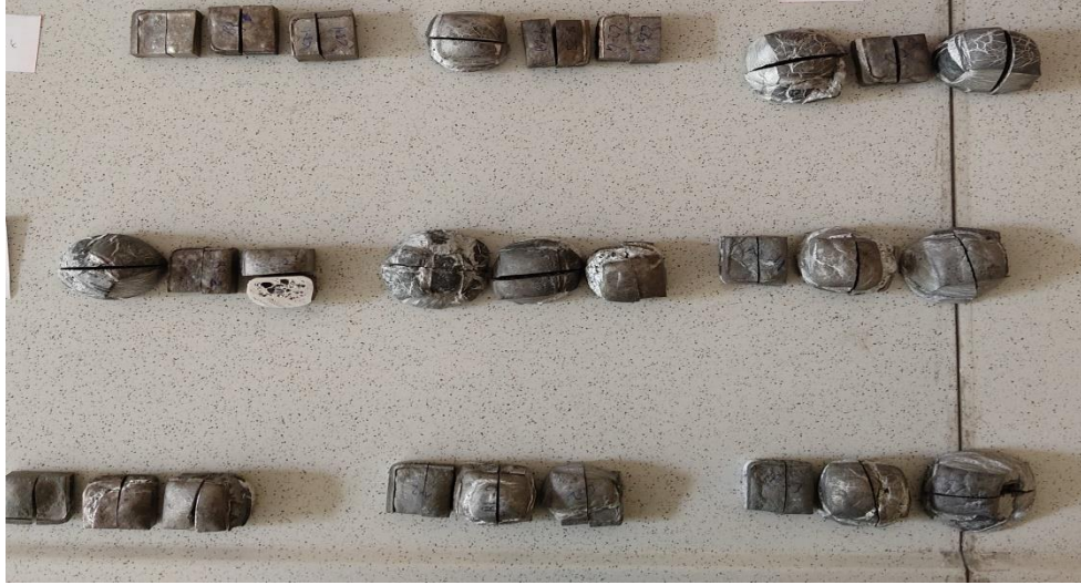
Şekil 5.6. Farklı sıcaklık ve sürelerde serbest köpürtülmüş alüminyum köpükler.
