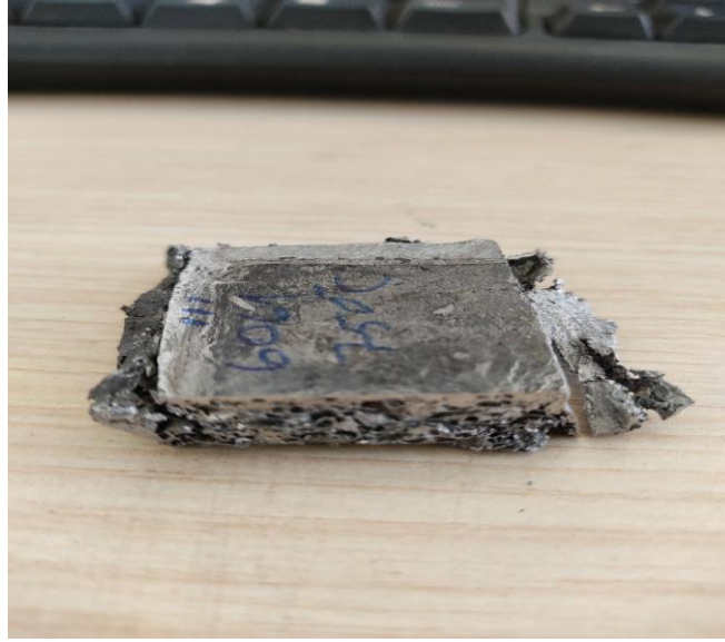
Şekil 6.8. Al6061 alaşımının 3. numunesinin 750°C’de maksimum sıkıştırma gerilimi 37,887 MPa olarak uygulanan basma sonucu fiziksel durumu.
