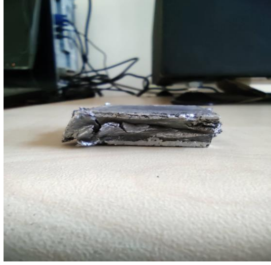
Şekil 6.9. Al2024 alaşımının 3. numunesinin 750 °C de maksimum sıkıştırma gerilimi 50,705 MPa olarak uygulanan basma sonucu fiziksel durumu.
