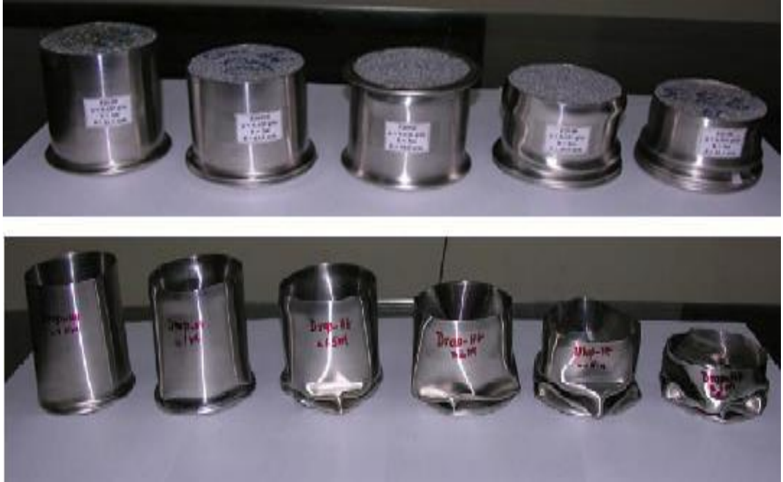
Őekil 2.12. arpıřma kutularının deformasyon sonucundaki grntleri.
