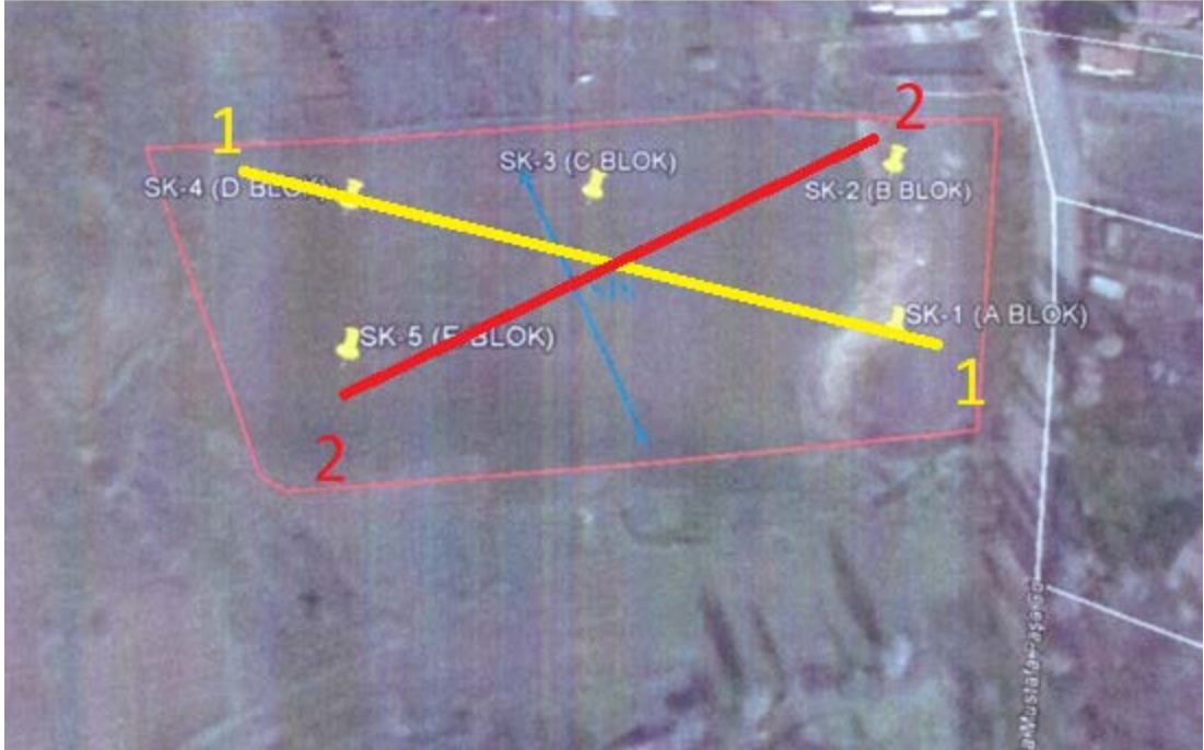
Şekil 3.14. Proje alanı profil görünümü ve sondaj noktaları.
