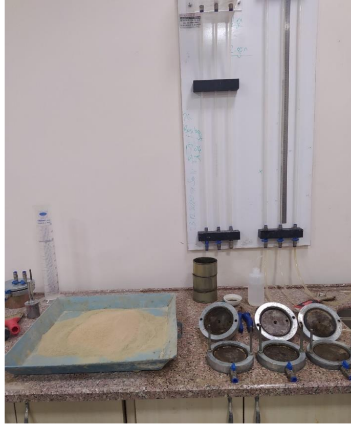
Şekil 2.14. Permabilite deneylerinin gerçekleştirildiği deney düzeneği.
