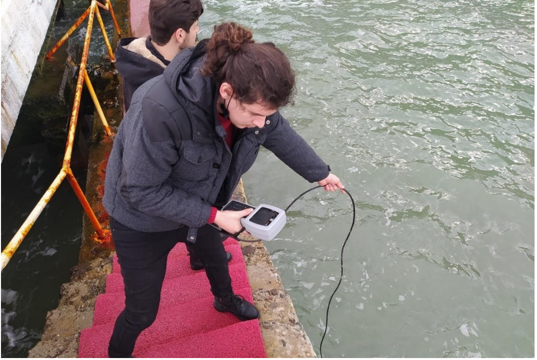
Şekil 2.2. Su numunelerinin alındığı lokasyonlarda EC ve pH ölçümü.
