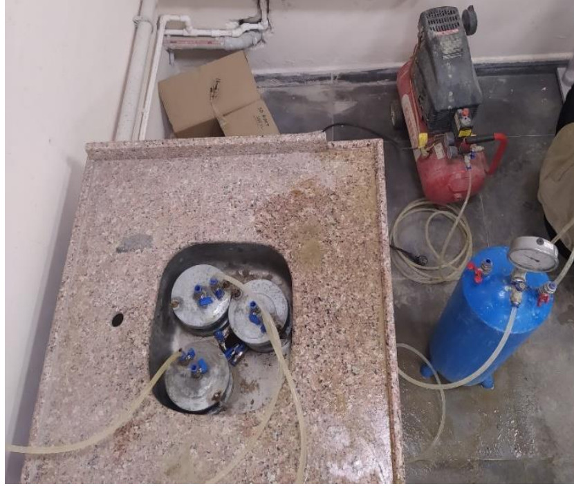
Şekil 2.15. Deney yapılırken kullanılan su tankı, kompresör ve deney düzeneği.
