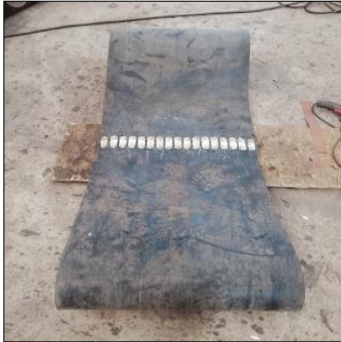
Şekil 3.38. Mekanik birleştirme yöntemi uygulanan bant.
