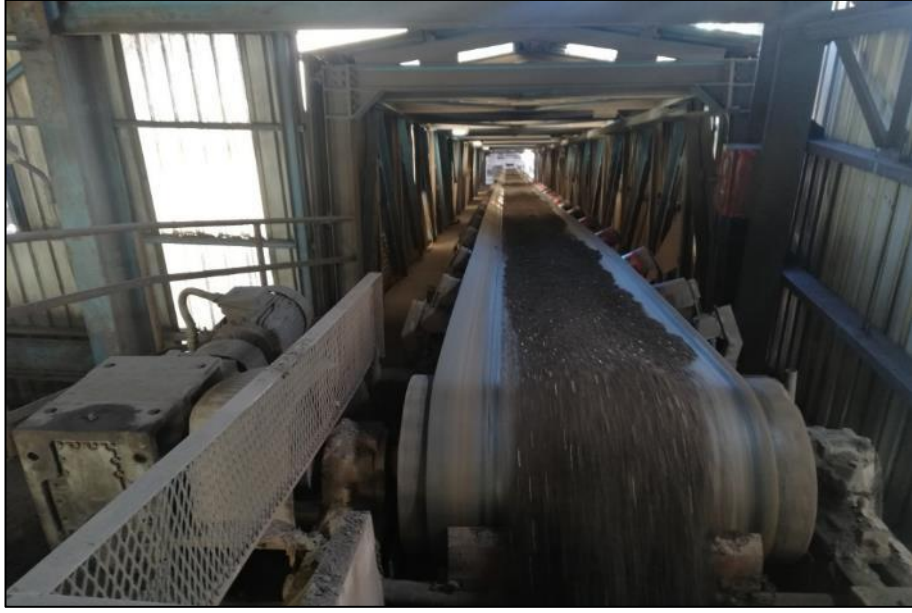
Şekil 2.3. Kardemir A.Ş. tesisinde kullanılan bantlı konveyör ile malzeme iletimi.
