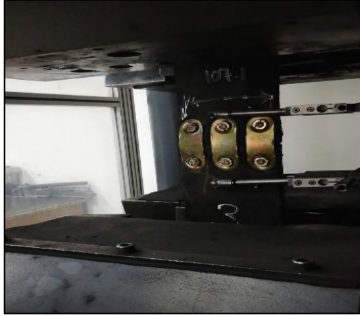
Şekil 5.10. Mekanik birleştirme yöntemi uygulanan bant çekme deneyi.
