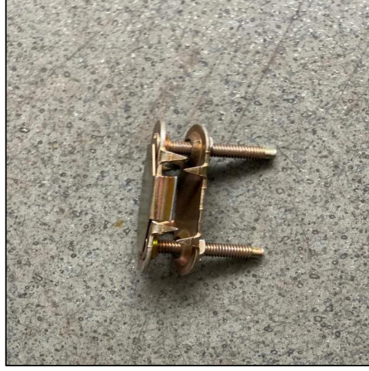
Şekil 3.32. Tesiste kullanılan bant raptiyeleri.
