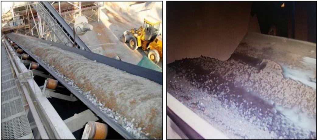
Şekil 2.22. O tipi yağa dayanıklı bant.
