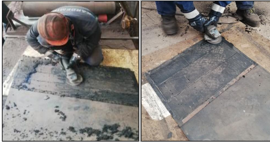
Şekil 3.21. Tekstil özlü bandın raspanması.
