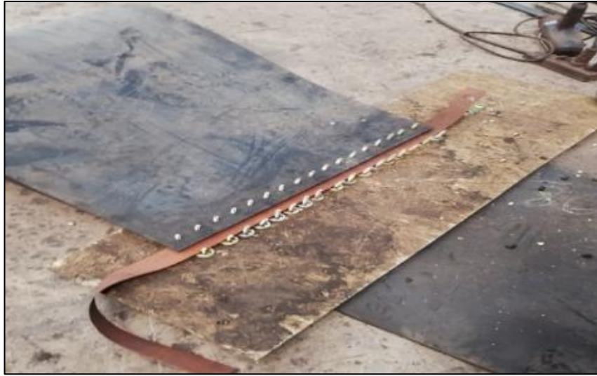
Şekil 3.36. Raptiye arası bez monte edilmesi.
