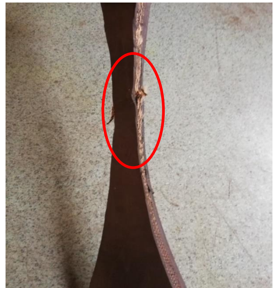
Şekil 6.1. Nomal, işlemsiz bant bant çekme deneyi kopması.
