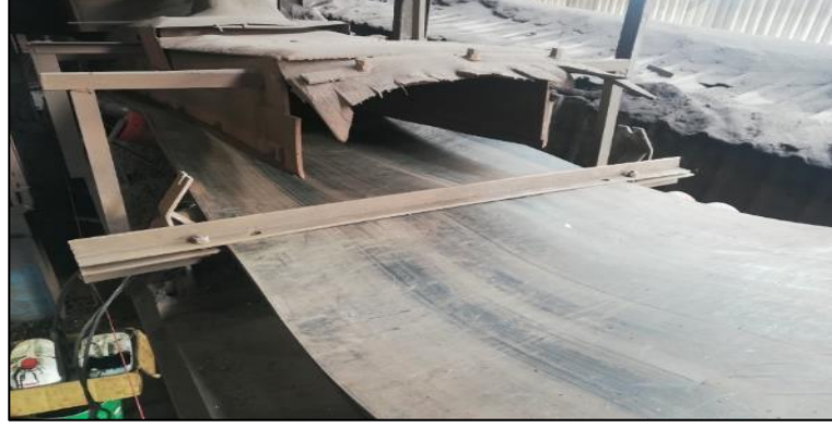
Şekil 3.10. Bantların köşebentlerle sabitlenmesi.
