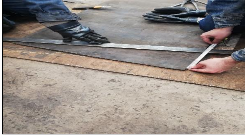
Şekil 3.12. Bant ek yeri markalama ve kesim işlemi.
