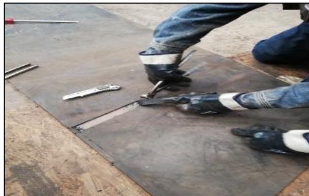
Şekil 3.13. Bant üst ekleme kauçuk kapağının kesilme işlemi.
