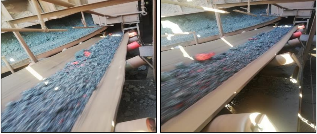
Şekil 2.21. Tesiste kullanılan T tipi ısıya dayanıklı bant.
