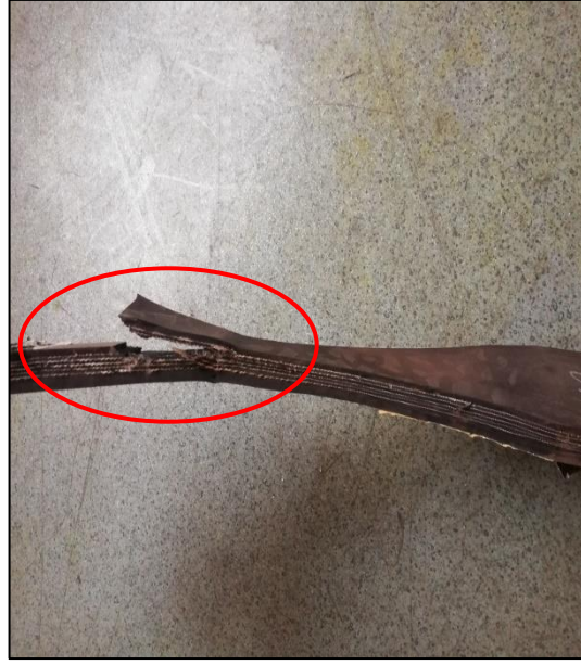
Şekil 6.3. Vulkanizasyon yöntemiyle birleştirilmiş bant çekme deneyi kopması.
