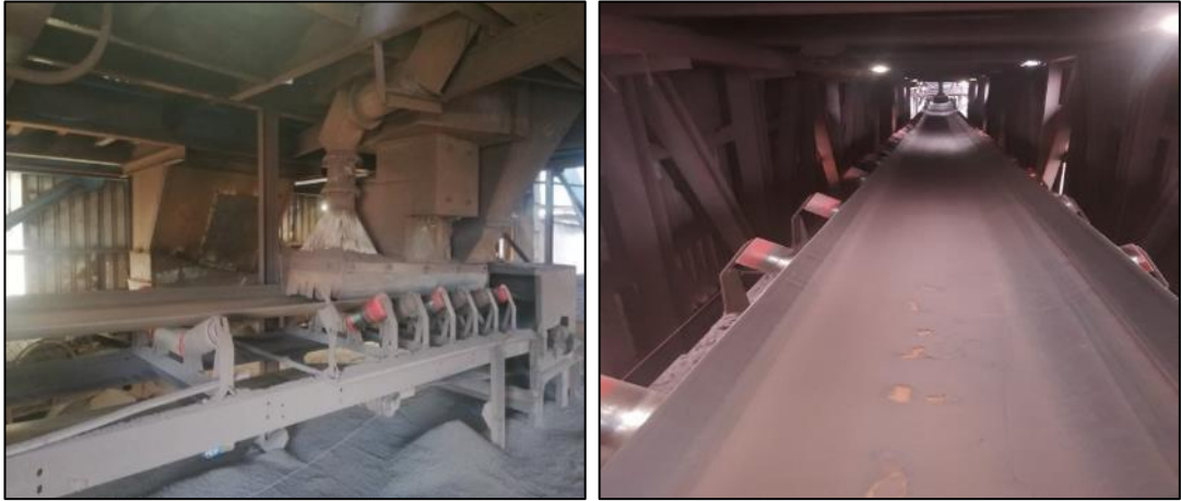
Şekil 2.20. Tesiste kullanılan A tipi aşınmaya dayanıklı bant.
