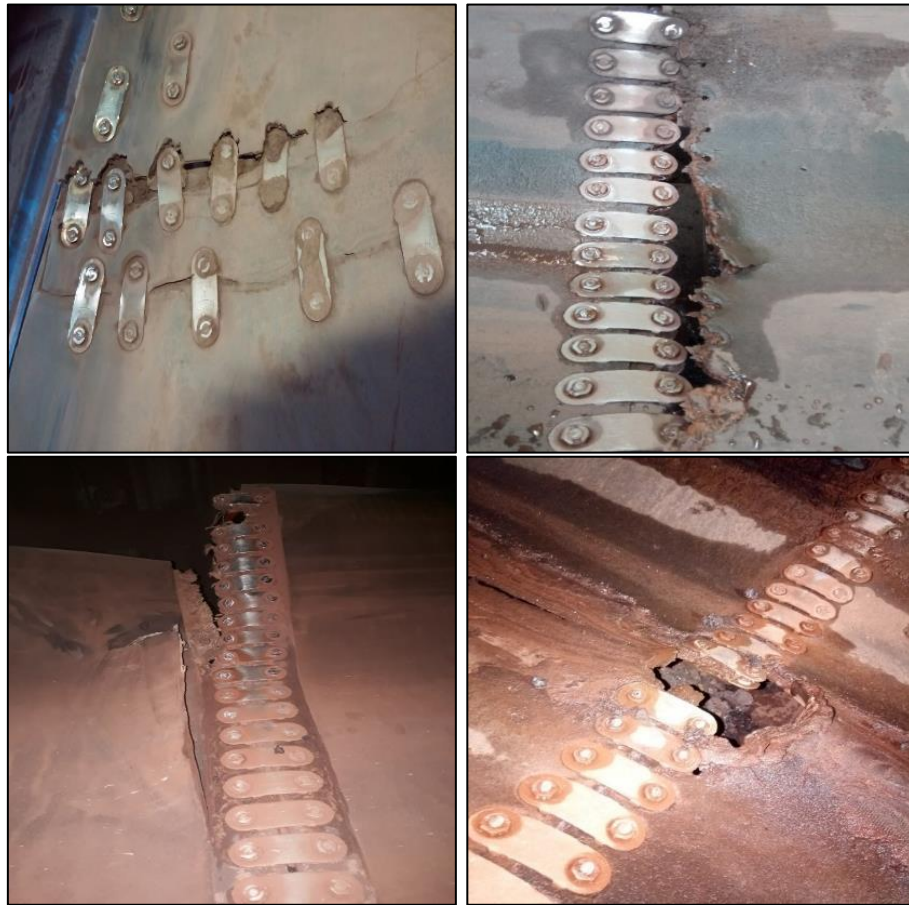
Şekil 3.2. Mekanik ek yeri hataları.
