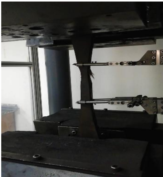
Şekil 6.1. Nomal, işlemsiz bant bant çekme deneyi kopması.
