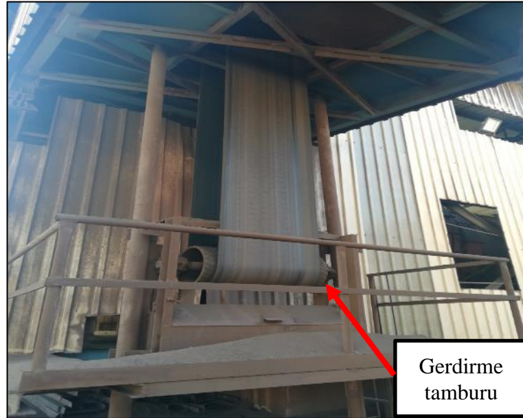
Şekil 2.7. Altına ağırlık asılmış gerdirme tamburu.
