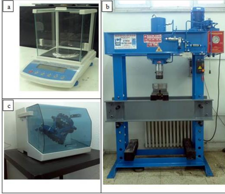
Şekil 4.2. Tez çalışması için kullanılan cihazlar a) hassas terazi, b) hidrolik pres ve üç eksenli karıştırıcı.
