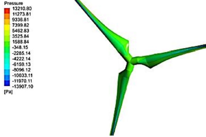
Şekil 3.47. Kanat Üzerindeki Basınç.
