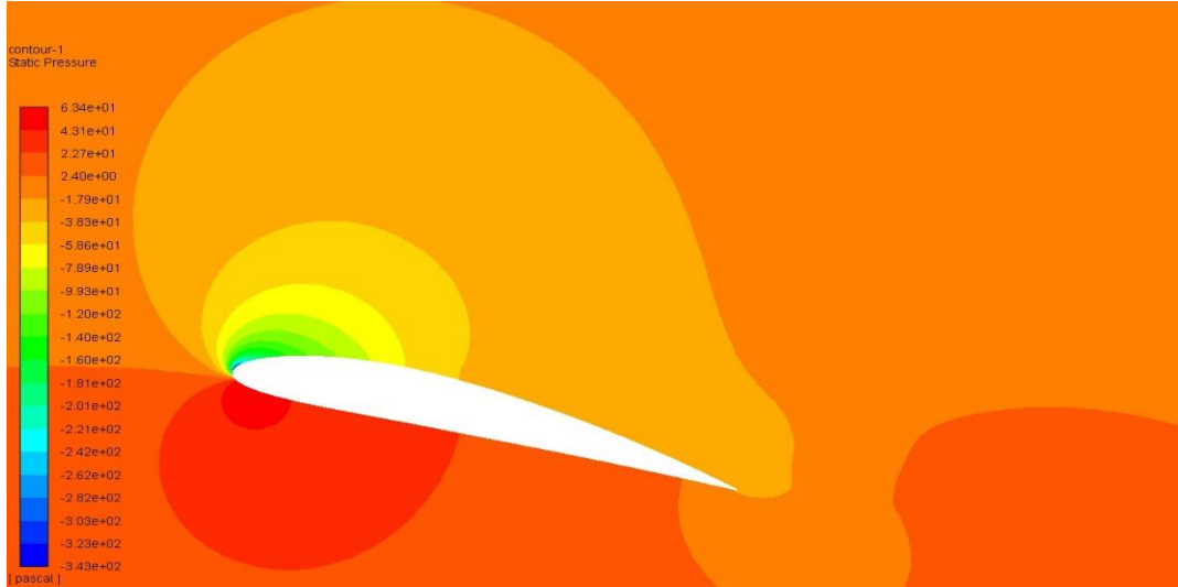
Şekil 3.19. NACA 4412 airfoilinun 15° hücum açısındaki basıncı.
