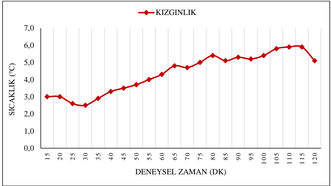
Şekil 6.2. Fanlı, nemlendiricili çalışma hali için buharlaştırıcı kızgınlığı.
