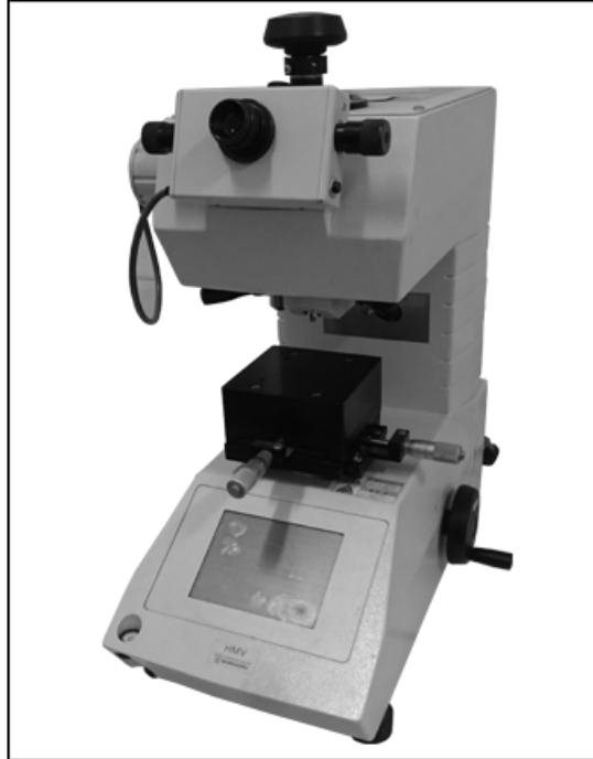
Şekil 5.4. Sertlik ölçümlerinin yapıldığı mikro sertlik cihazı görüntüsü.
