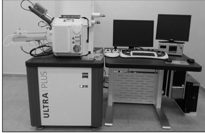
Şekil 5.5. SEM ve EDS analizlerinin yapıldığı tarama elektron mikroskopu görüntüsü.
