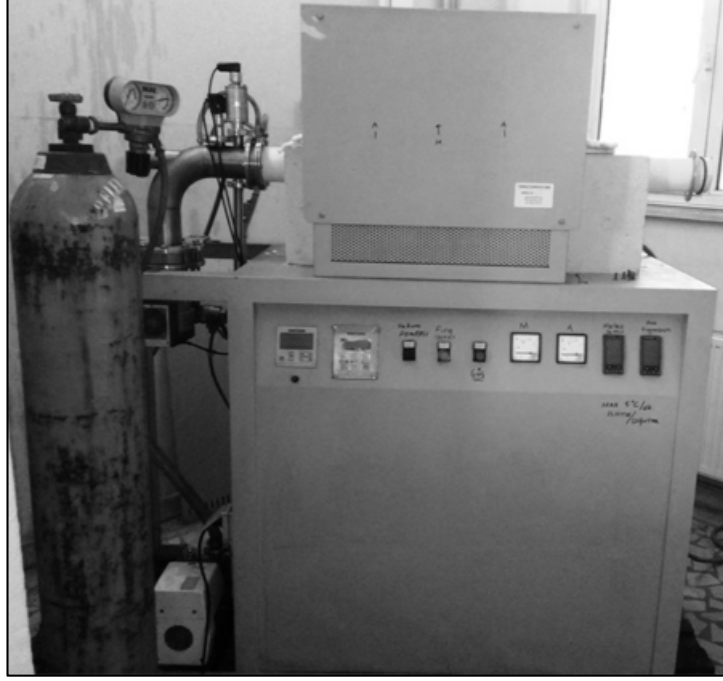
Şekil 5.3. Sinterleme işleminin yapıldığı ısıtma fırını görüntüsü.
