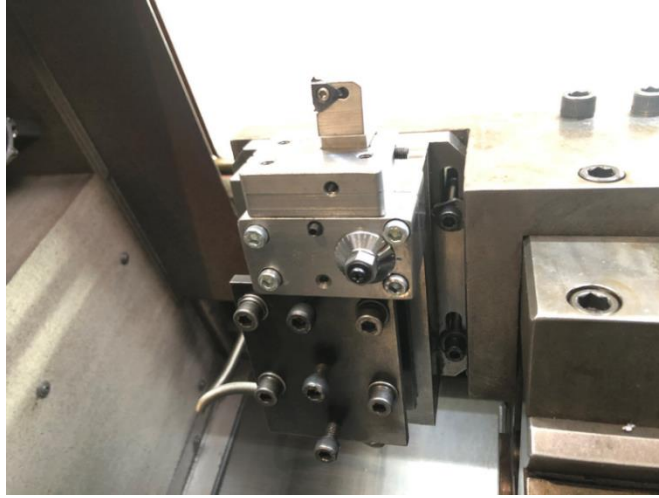
Şekil 4.14. Vida eğim açısına ayarlı Takım B'nin tezgah üzerinde dinamometreye bağlanmış görseli
