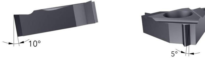
Şekil 4.16. Kesici uç radyal ve serbest yüzey boşluk açısı
