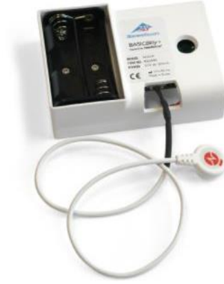
Şekil 2.14. BASICBilley+ model CPR mankeninde kullanılan veri alma modülü.
