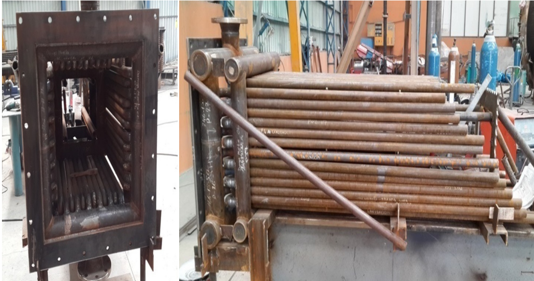
Şekil 4.17. Kardemir A.Ş BOF flux şüt detay imalat projesi.
