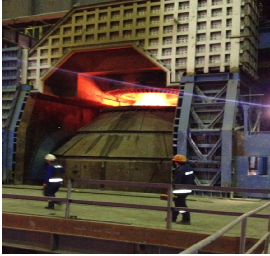
Şekil 2.1. 120 ton sıvı çelik kapasiteli BOF saha fotoğraf görüntüsü.
