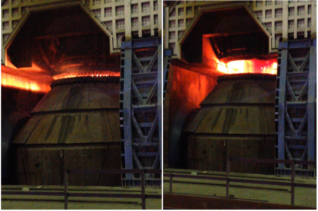
Şekil 2.7. BOF ile sıvı çelik üretim prosesi esnasında etek mekanizmasının a) kapalı pozisyonundaki durumunu gösteren saha görüntüsü b) açık pozisyonundaki durumunu gösteren saha görüntüsü.
