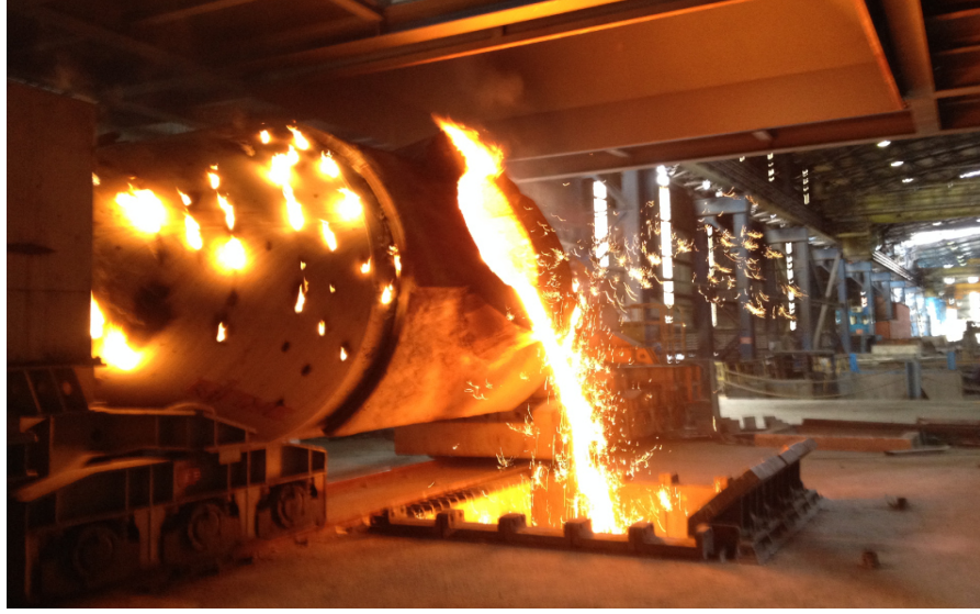
Şekil 2.2. Torpedodan sıvı ham demir aktarma çukuruna sıvı ham demirin boşaltılma anı.
