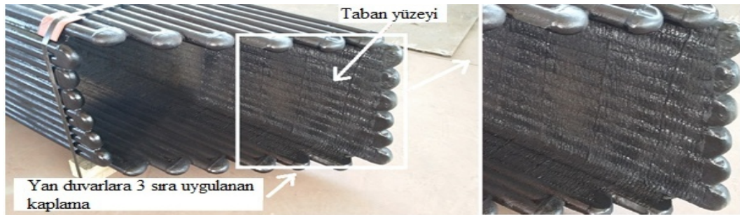
Şekil 4.20. Kardemir A.Ş BOF flux şut kaplama sonrası yakın fotoğraf görüntüsü.
