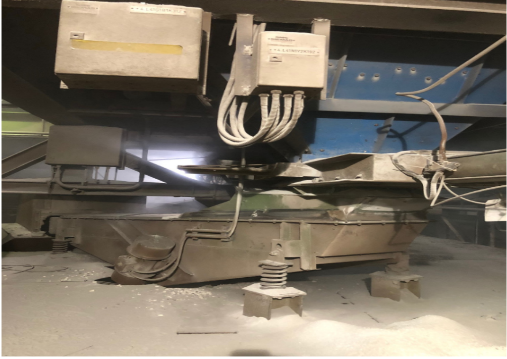
Şekil 4.5. Kardemir A.Ş BOF elektromanyetik besleyicinin görüntüsü.
