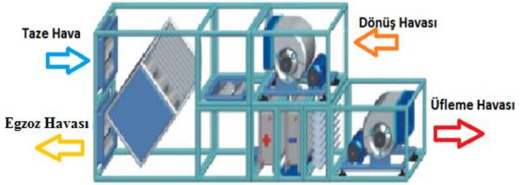
Şekil 3.8. Klima santralinde çapraz akışlı plakalı ısı geri kazanım ünitesi.
