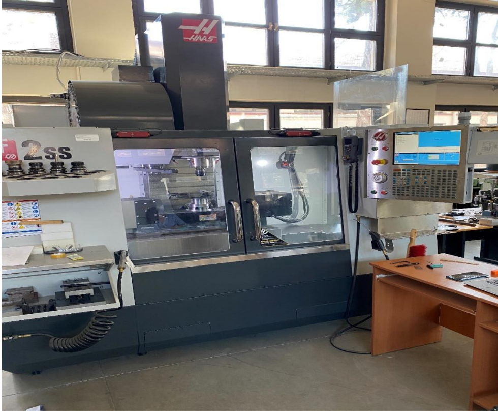
Şekil 4. 3. Deneylerde Kullanılan Delik Delme Tezgâhı
