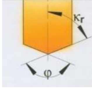
Şekil 3. 5. Matkabın Uç Açısı ve Kesme Kenar Açısı
