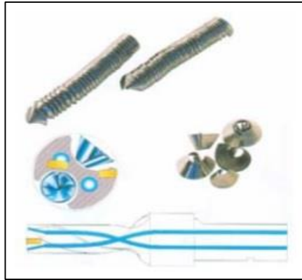
Şekil 3. 6. Delik Delme İşlemlerinde Talaş Oluşumu, Talaş tahliyesi ve Kesme Sıvısı Temini [46]
