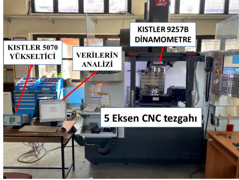
Şekil 4. 4. Delik Delme Deney Düzeneği ve Kesme Kuvvetlerinin Ölçülmesi
