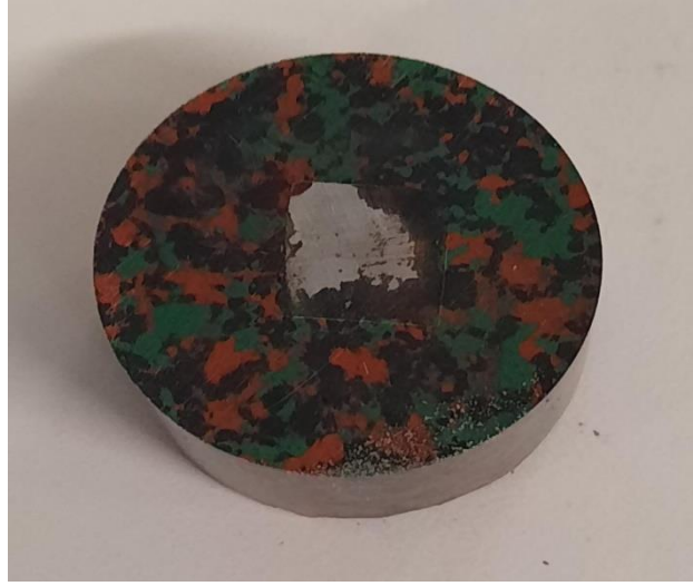
Şekil 7.1. Bakalite kaplanmış numune.
