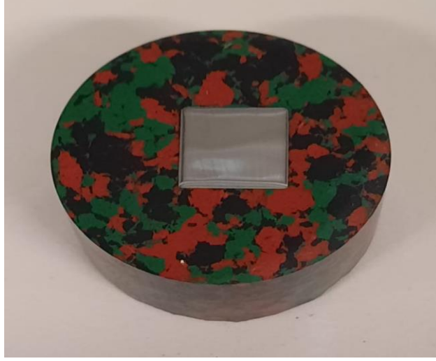
Şekil 7.2. Zımparalama ve parlatma işlemleri uygulanmış numune.
