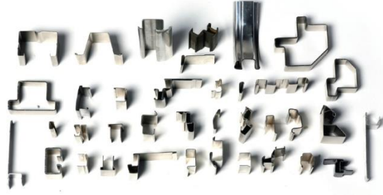
Şekil 2.2. Makara ile sac şekillendirme yöntemiyle üretilen örnek profiller [19].
