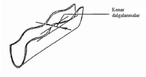
Şekil 2.25. U kesitli bir profildeki kenar dalgalanmalar [41].
