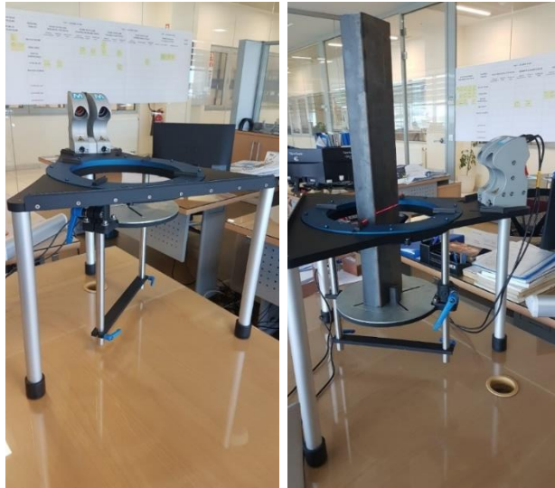
Şekil 4.9. COPRA ® DT 200 lazer profil tarama cihazı.
