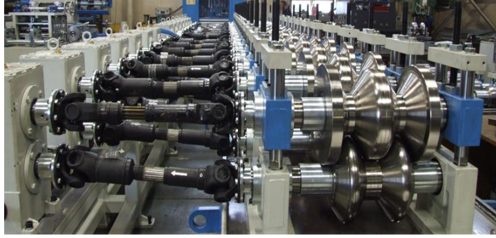
Şekil 2.7. Ağır seri kasetli tip roll form makinası [22].
