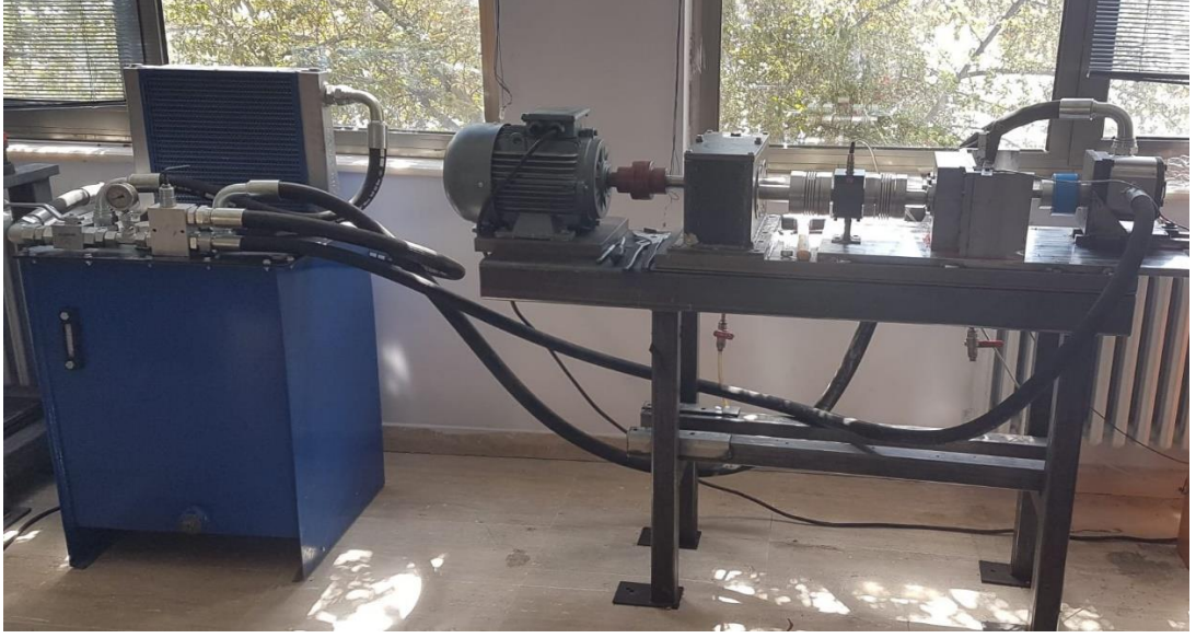
Şekil 5.10 b. Dişli aşınma deneyi test cihazı.
