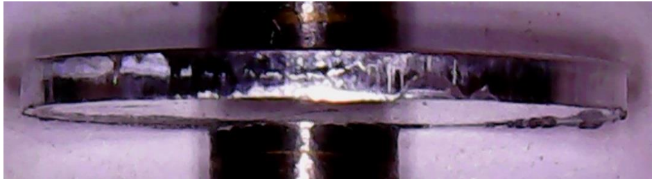
Şekil 6.44. P1 (0°) düz zımba artık parça profili.
