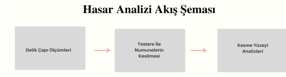
Şekil 5.7. Hasar analizi incelemeleri akış şeması.
