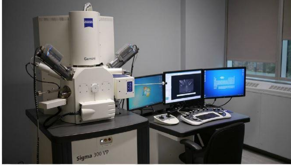
Şekil 3.3. Carl Zeiss ultra plus gemini FESEM.
