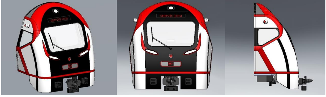
Şekil 5.13. Metro şasi sökülebilir sürücü kabini.
