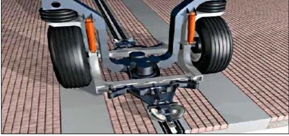
Şekil 2.9. Translohr tekerlek ve süspansiyon sistemi.
