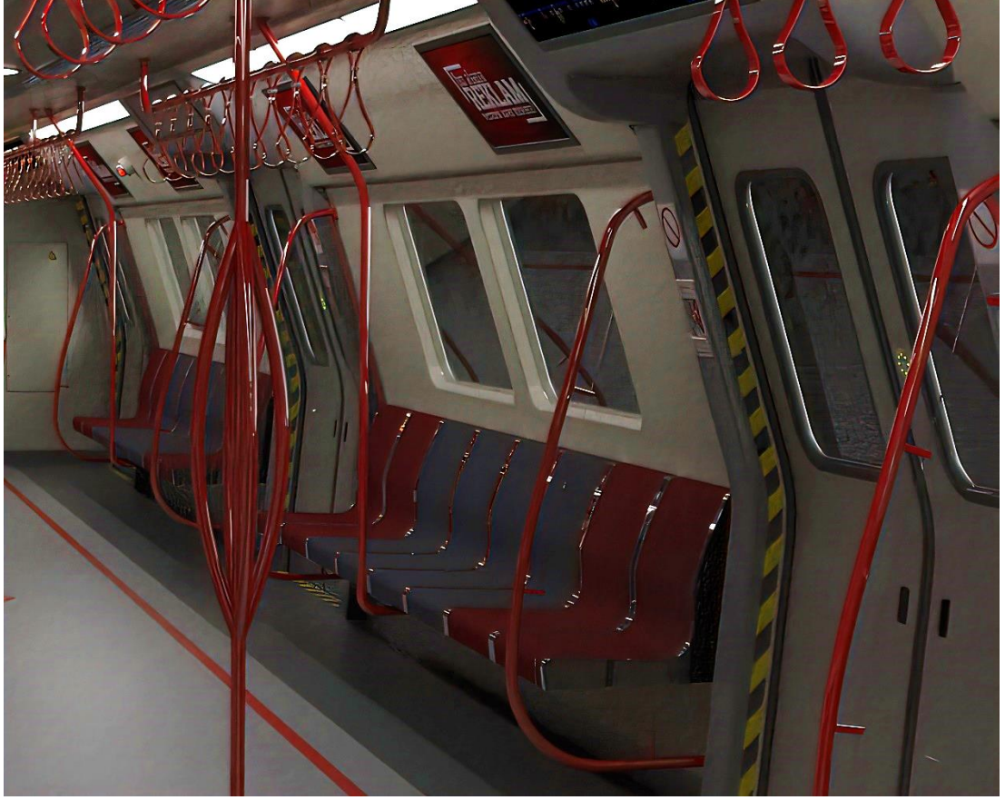
Şekil 5.7. Metro yolcu koridoru ve tutunma elemanları.
