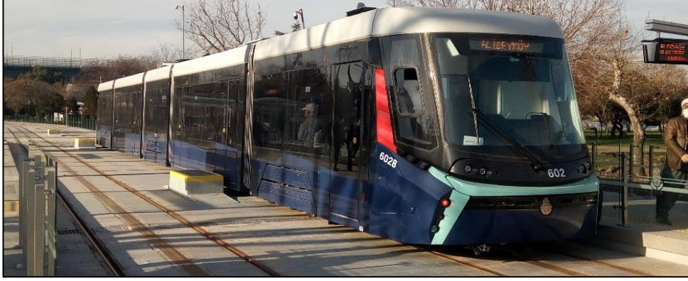
Şekil 2.5. İstanbul Alibeyköy - Eminönü tramvayı (Katenersiz, sürekli yerden beslemeli üçüncü ray sistemi).
