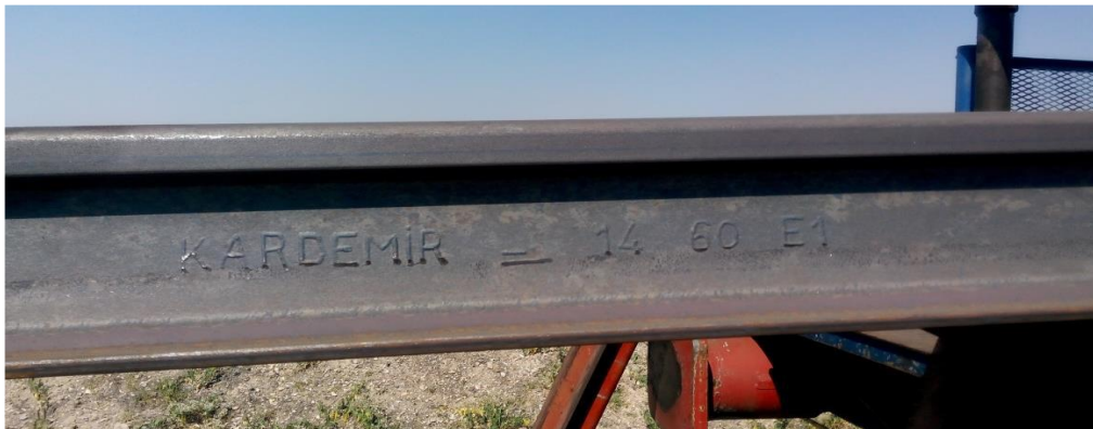
Şekil 2.2. Rayın üzerinde yazan bilgiler [5].
