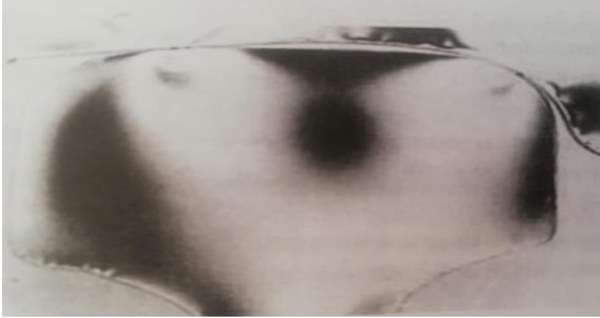
Şekil 4.5. (b) Çift nokta temasında ray iç gerilmeleri[4].
