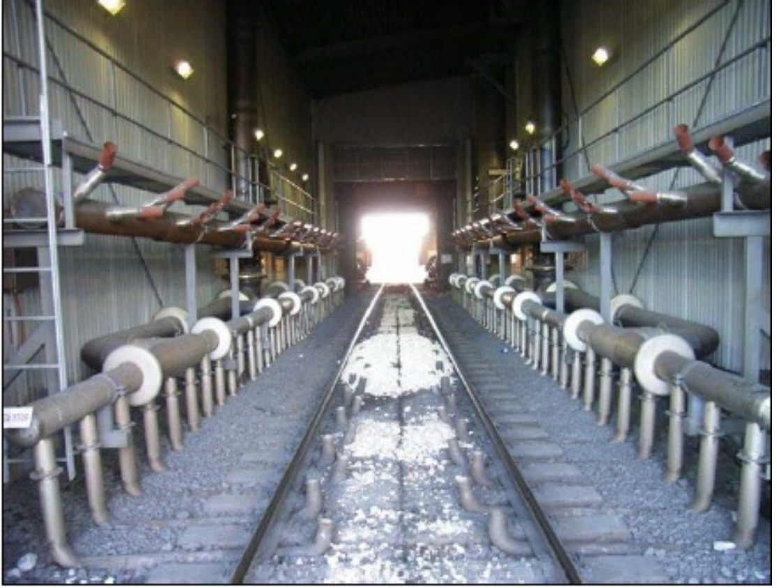
Şekil 2.2. Svappavaara bölgesindeki vagon ısıtma holü iç dizaynı.
