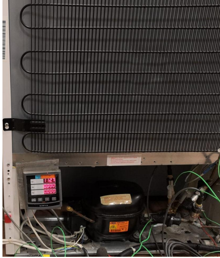
Şekil 4.1. Soğutma sisteminde kullanılan basınç ve sıcaklık sensörlerinin yerleşimi.
