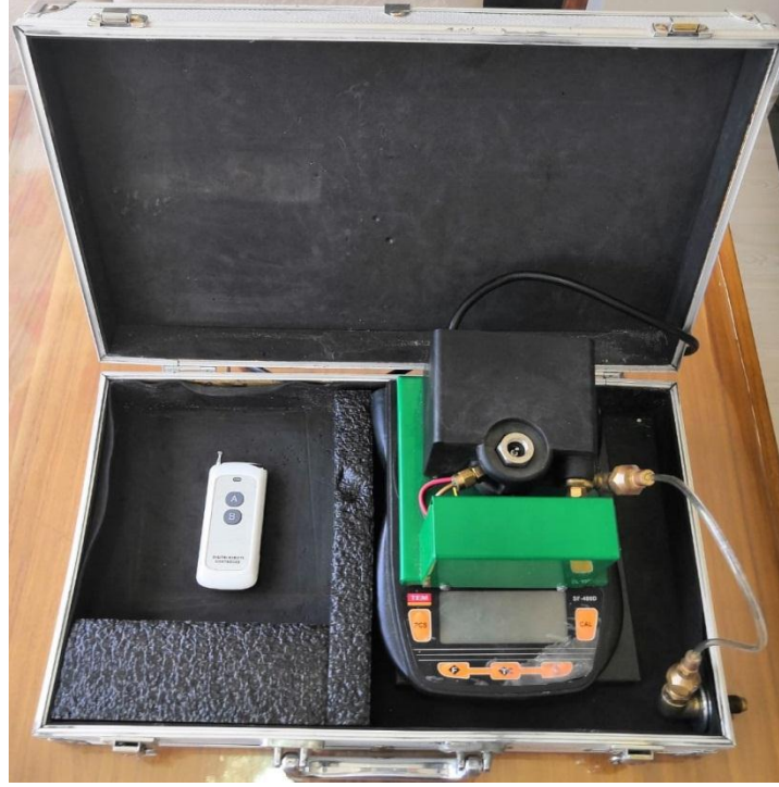
Çizelge Ek F.1. Soğutucu akışkan şarjı ve tartı mekanizması.
