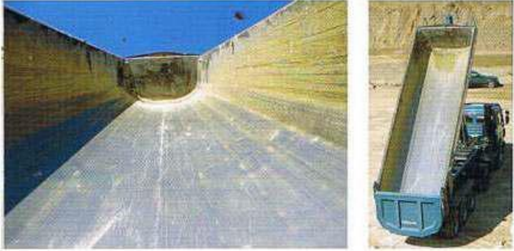
Şekil 5.1. Hardox aşınma levhasından imal edilmiş bir damper kasası [8].
